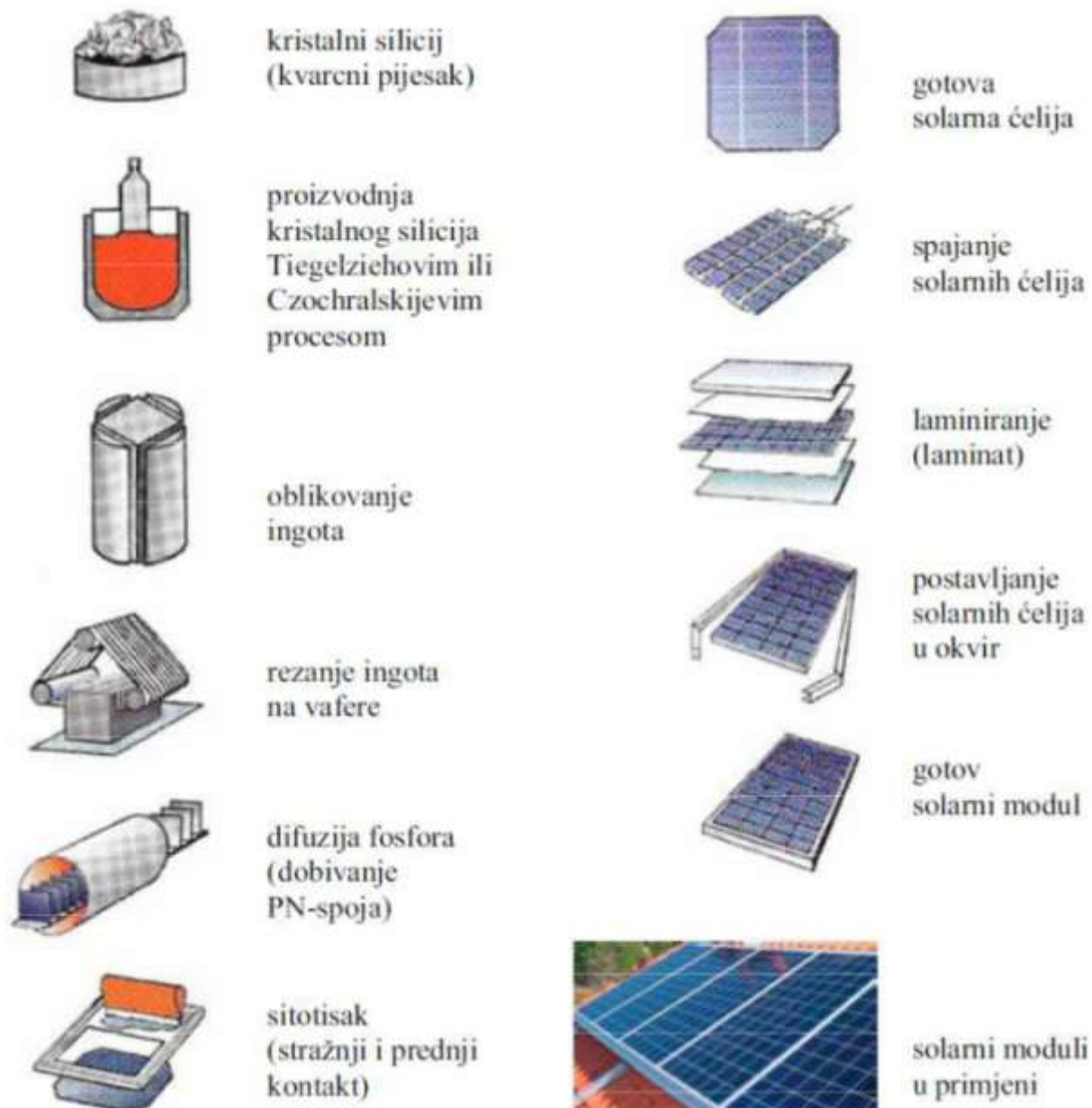
SLIKA 3.3. Postupak proizvodnje solarnih ćelija i FN modula [4]
