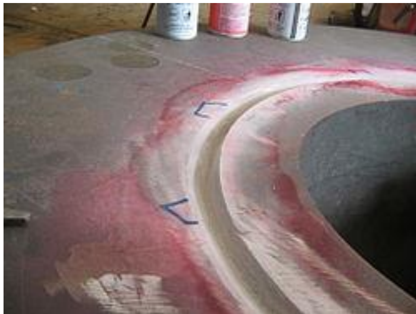
Slika 5.11 Izgled zavora kod penetrantskog ispitivanja [32]
