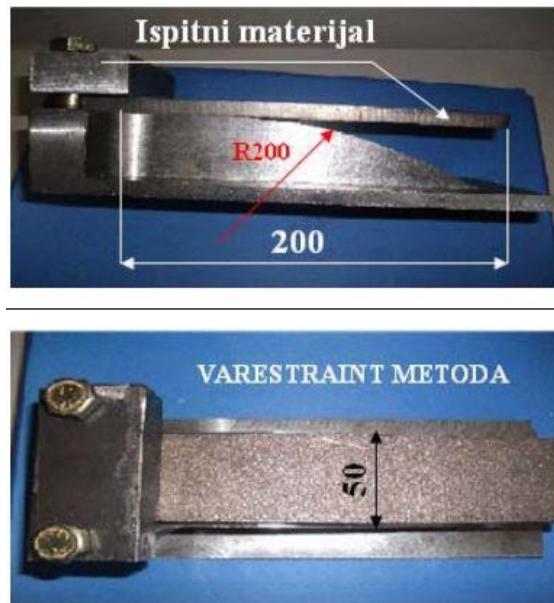
Slika 4.15 Praktičan izgled Vareststraint metode sa radijusom zakrivljenja R200 mm [26]
