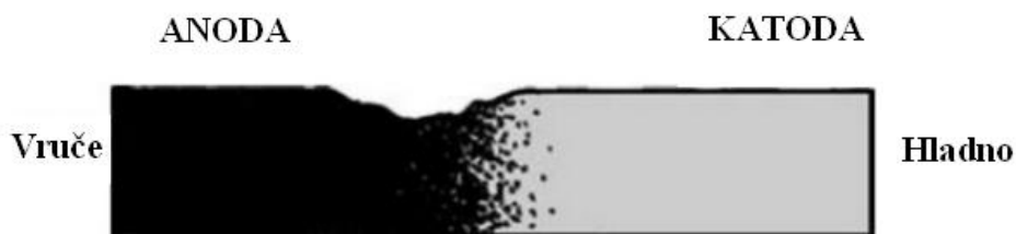
Slika 4.23 Primjer principa termogalvanske korozije [9]
