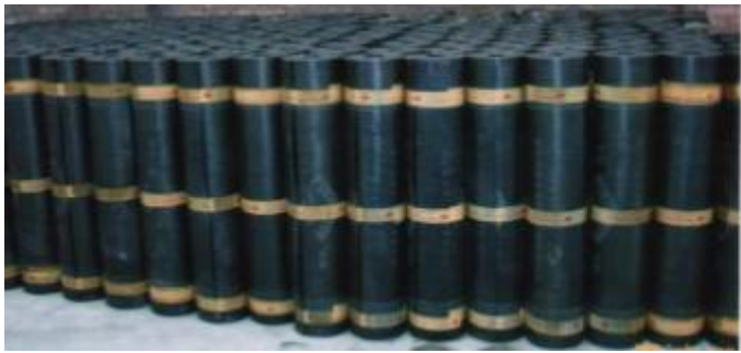
Slika 5.15 Izgled tkanine za bitumenizaciju i postupak bitumeniziranja lijepljenjem [51]
