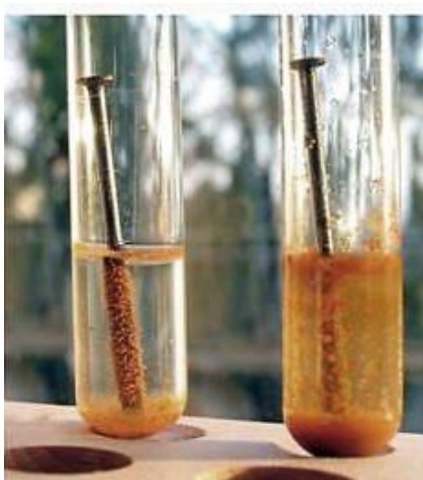
Slika 4.8 Izgled novih željeznih čavala nakon 7 dana stajanja u običnoj (lijevo) i slanoj vodi (desno) [17]
