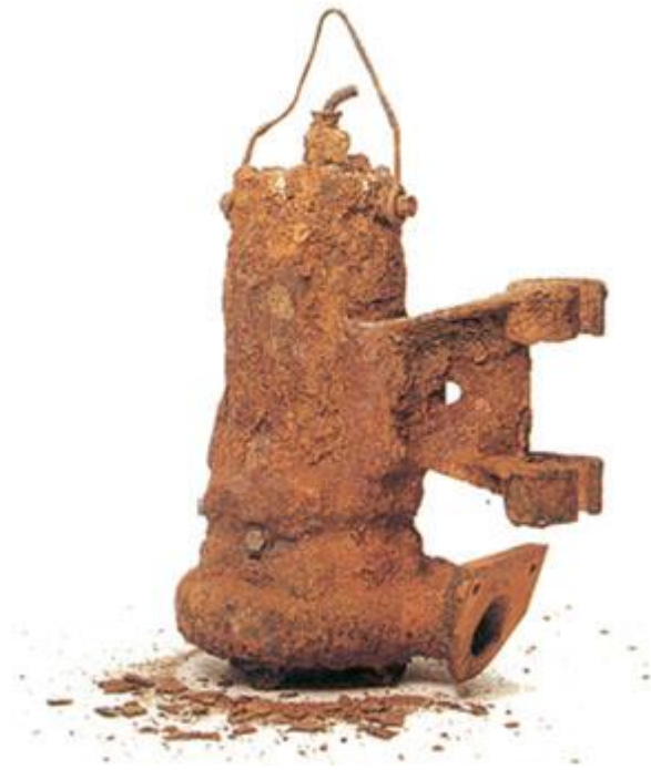
Slika 4.10 Primjer opće korozije pumpe od ljevanog željeza [22]
