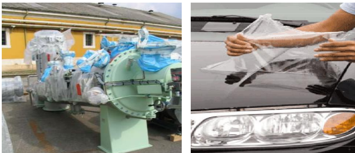
Slika 5.22 Zaštita metala slabo propusnim omotom i skidanje zaštitne folije s automobila [55]
