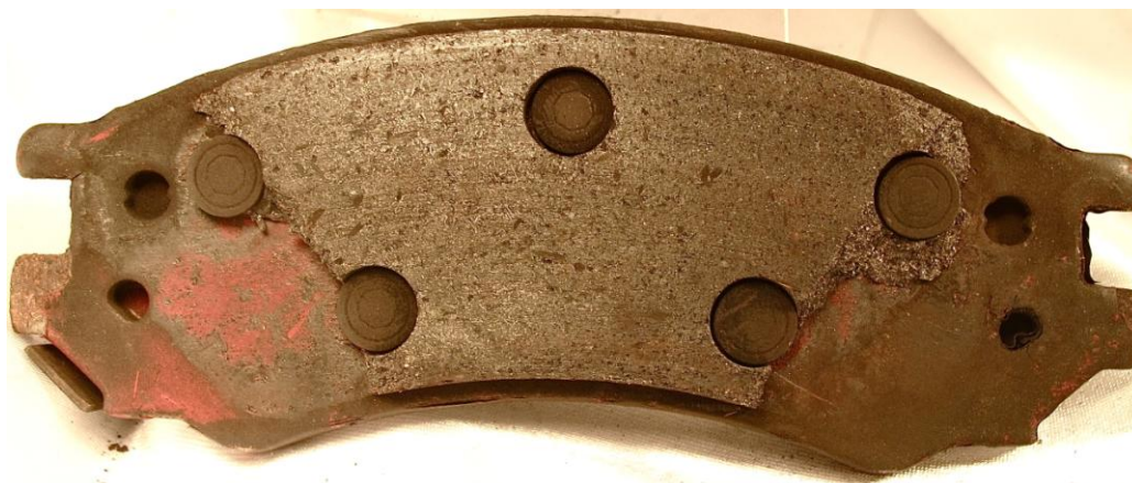
Slika 4.26 Primjer korozije uzrokovane trenjem kod automobilskih kočnica[36]
