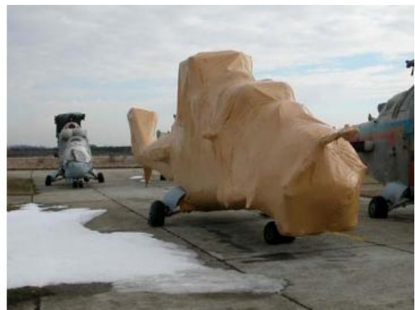
Slika 5.24 Primjena inhibitora korozije u vojnoj industriji [55]
