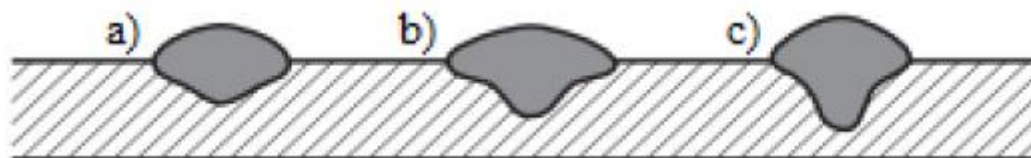
Slika 8.7 Utjecaj jakosti struje na zavar [18]
