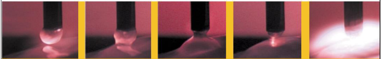
Slika 9.1 Slijed odvajanja kapljice kod STT postupka zavarivanja [23]
