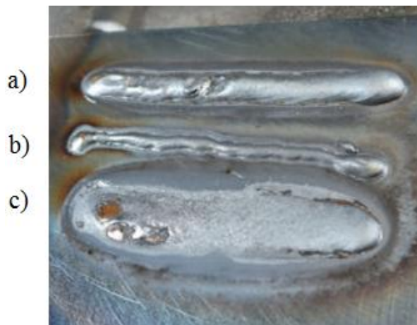
Slika 8.11 Realni prikaz izgleda zavora o zavisnosti na brzini zavarivanja [22]
