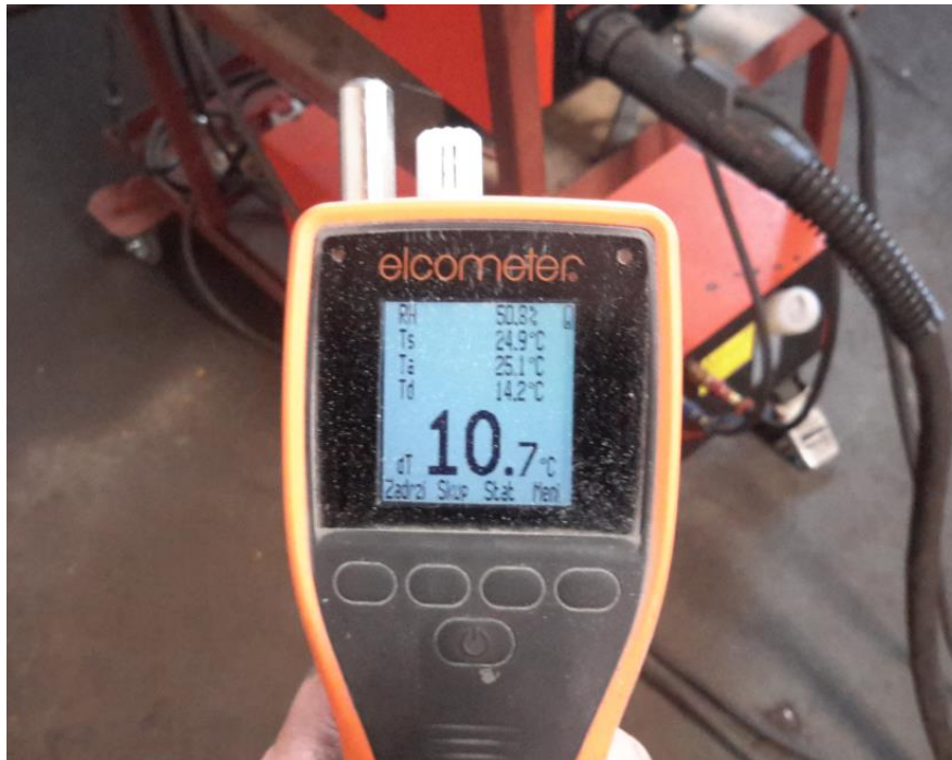
Slika 6.2. Mjerenje temperature i relativne vlažnosti okoline
