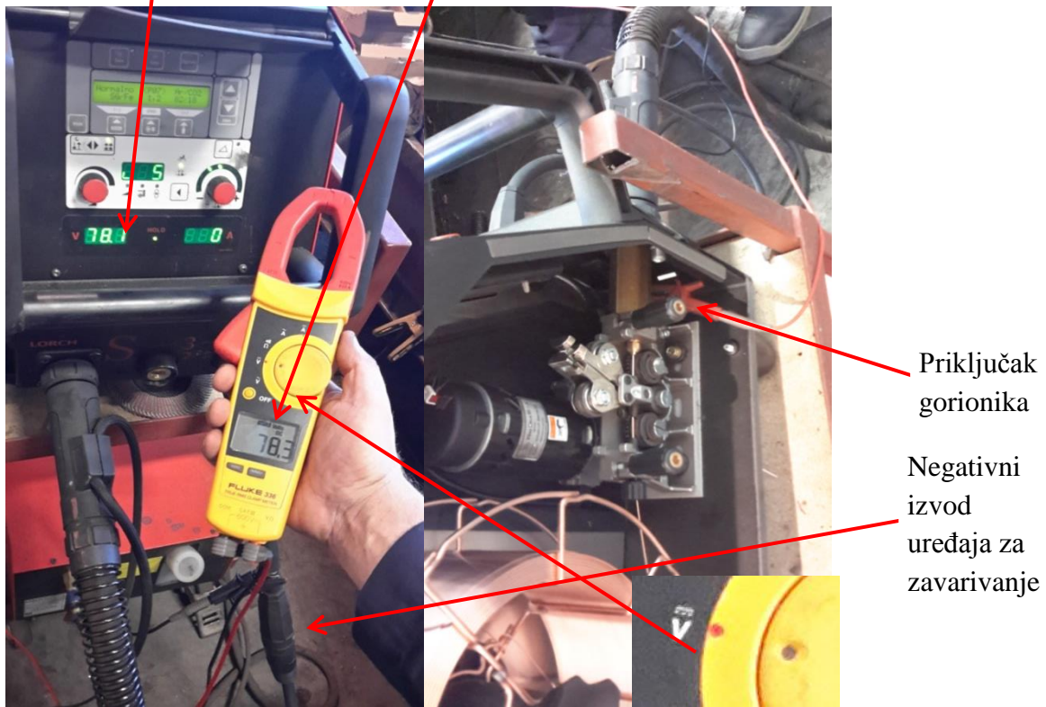
Slika 6.5. Mjerenje napona praznog hoda
