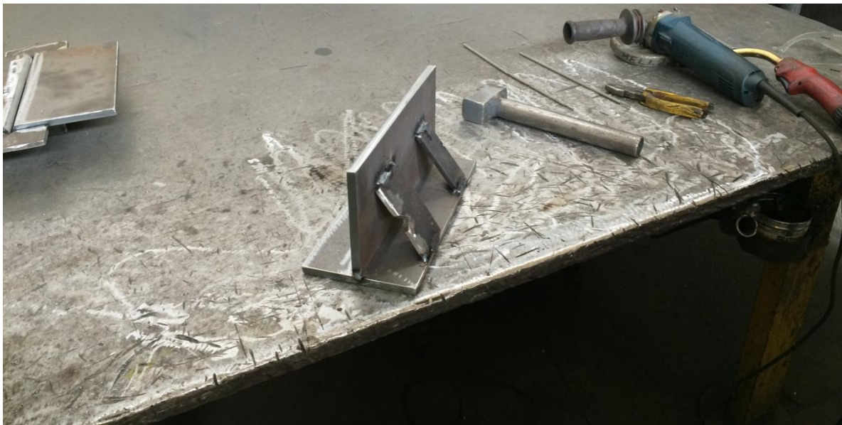
Slika 5.9. Spoj ispitnih ploča za kutni zavar
