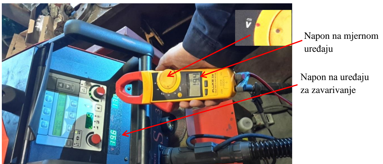
Slika 6.6. Mjerenje napona zavarivanja
