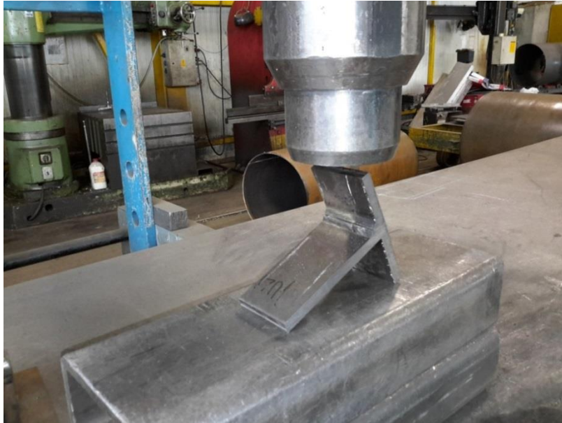
Slika 5.27. Ispitivanje loma – početak ispitivanja
