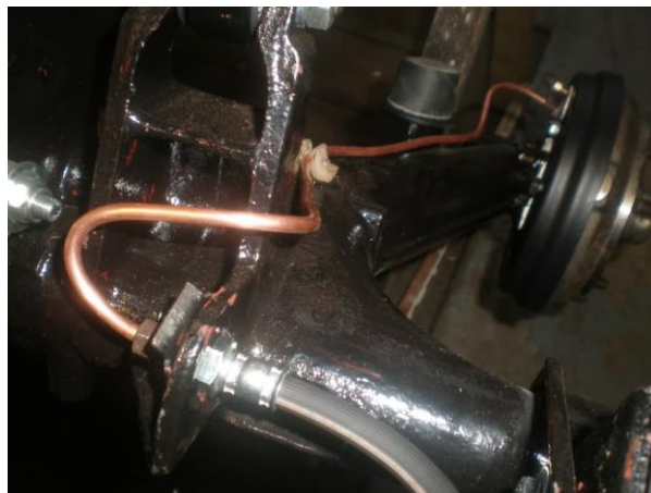
Slika 5.3.1 Izmjenjena metalna i fleksibilna cijev
