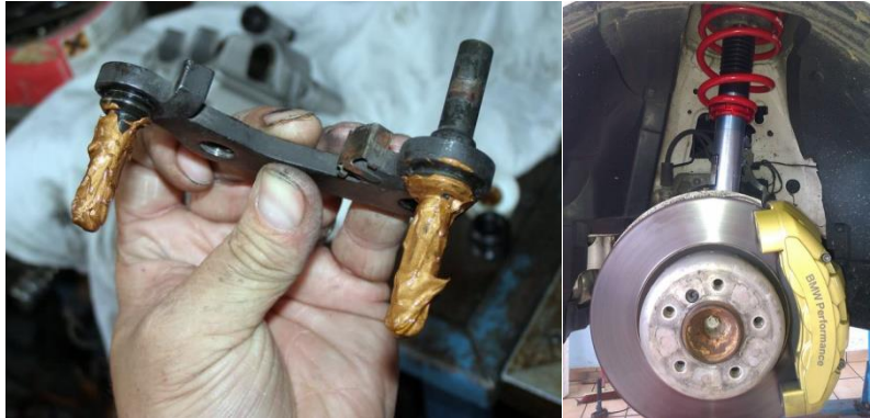
Slika 5.6.1 Podmazan i očišćen kočioni sustav
