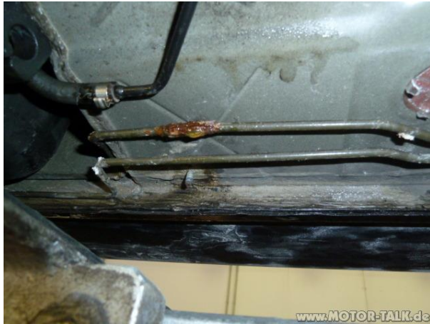
Slika 5.2.1 Korodirana kočiona cijev
