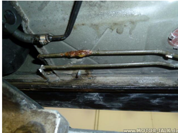
Slika 5.2.1 Korodirana kočiona cijev
