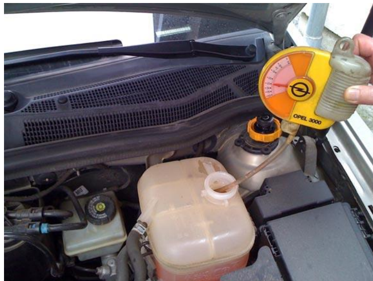
Slika 3.7.1 Provjera nivoa i temperature smrzavanja rashladne tekućine
