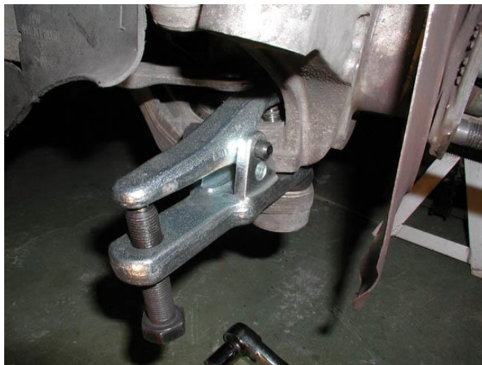
Slika 6.2.1 Zamjena kugle sa specijalnim alatom
