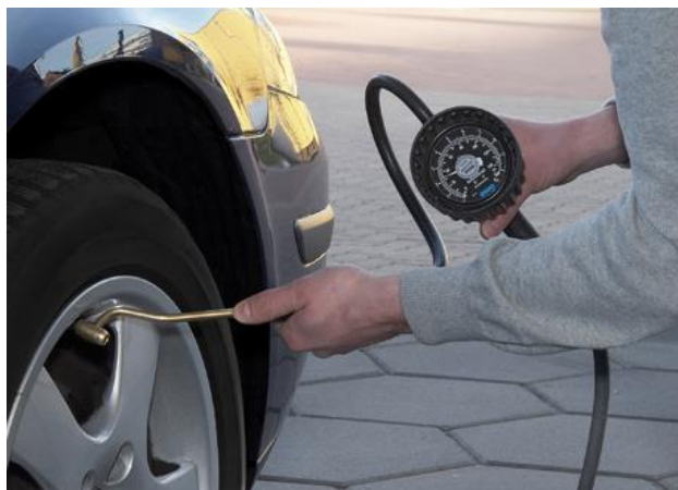
Slika 8.1.1 Provjera tlaka guma
