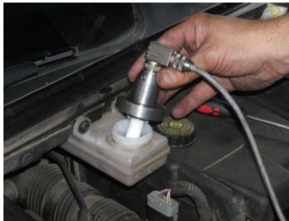
Slika 5.1.1 Mjerenje vrelišta kočionog ulja
