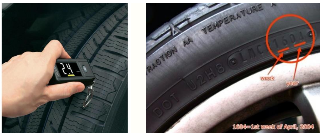
Slika 8.1.2 Provjera dubine šara i datum proizvodnje guma
