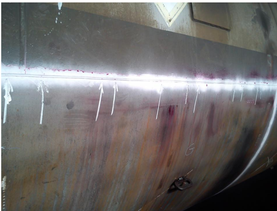
Slika 31. Mrlje na razvijaču koje označuju nepravilnosti
