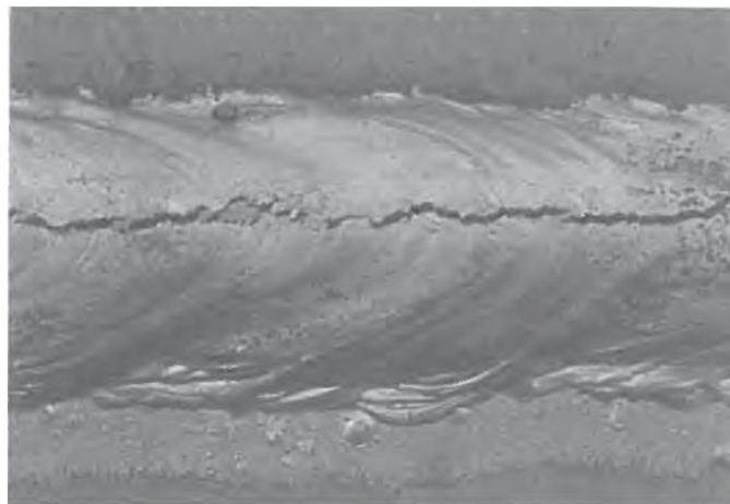
Slika 6. Karakteristična topla pukotina kod zavarivanja aluminija – sučeoni spoj [1]
