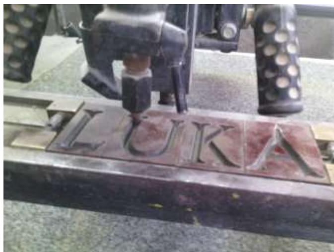
Slika 2.10. Vođenje vodilice po šabloni
