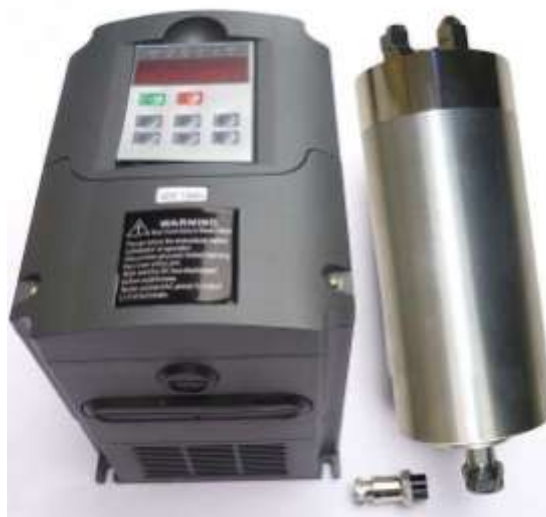
Slika 4.11. Motorvreteno s sustavom vodenog hlađenja
