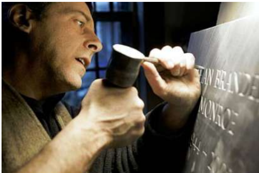
Slika 2.1. Ručno graviranje (klesanje)
