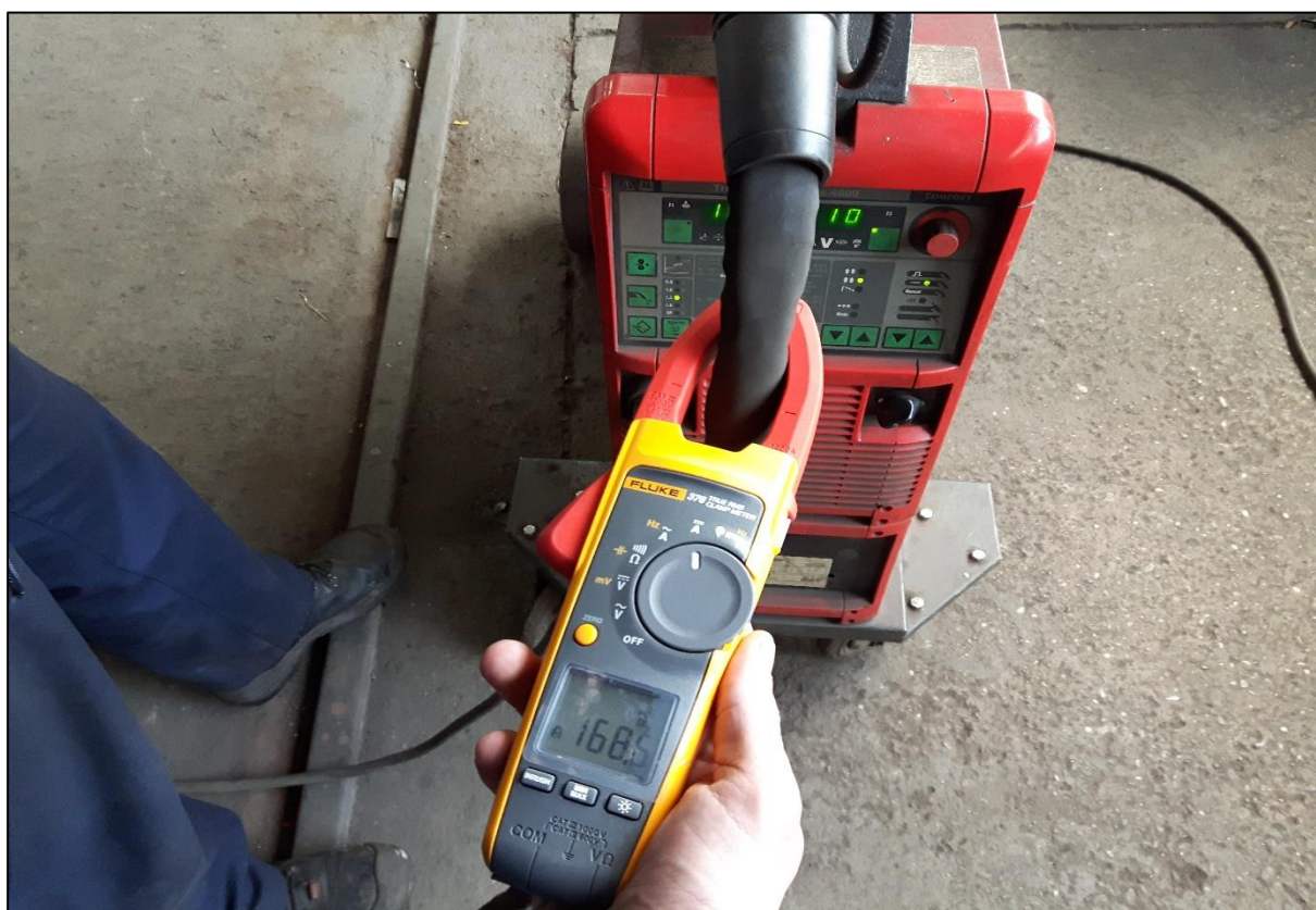
Slika 9.4 Mjerenje struje zavarivanja obuhvatnim ampermetrom (strujnim kliještima)
