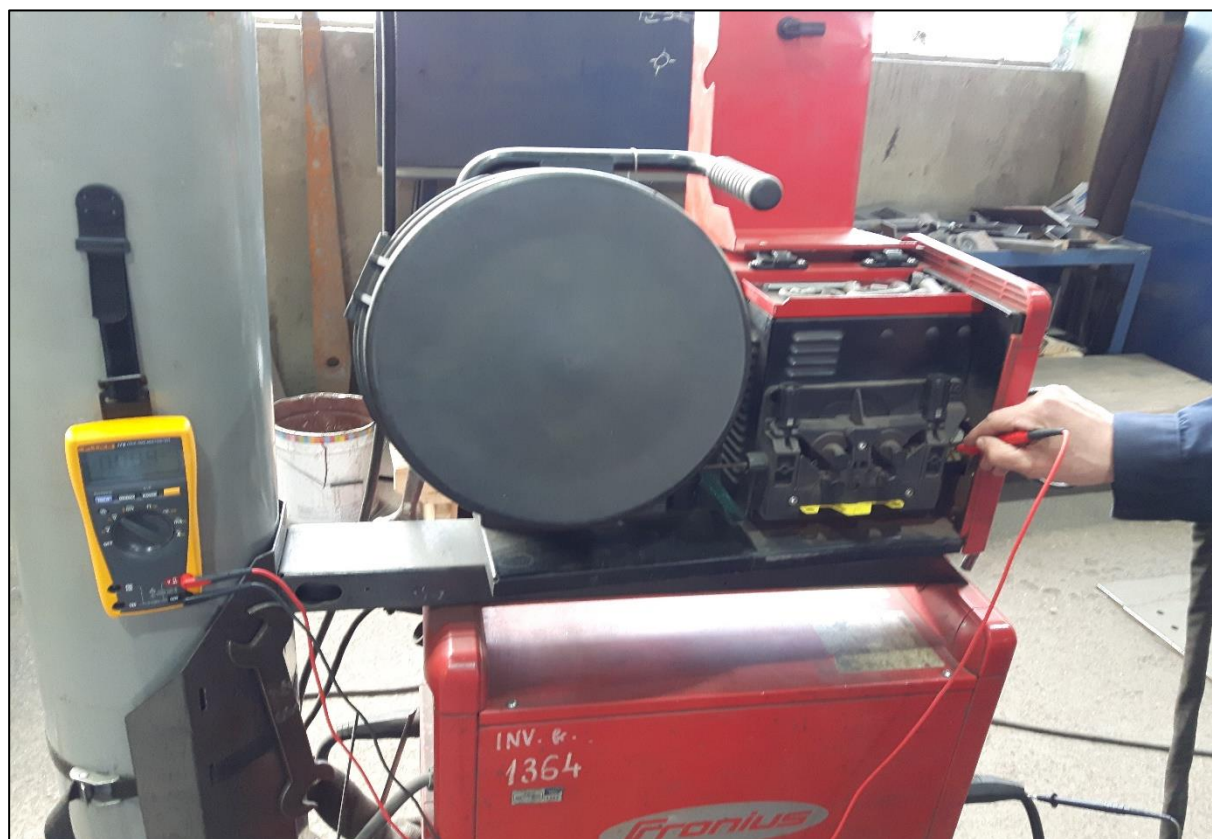
Slika 9.2 Spajanje voltmetra za mjerenje napona praznog hoda
