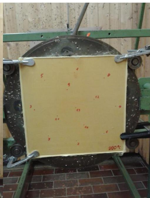
Slika 4.4. Stezanje i namještanje ploče
