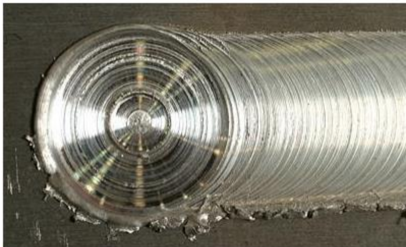
Slika 31 Izgled rubova zavara nastalih djelovanjem alata [21]
