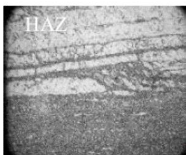
Slika 27 Mikrostruktura zone utjecaja topline [18]
