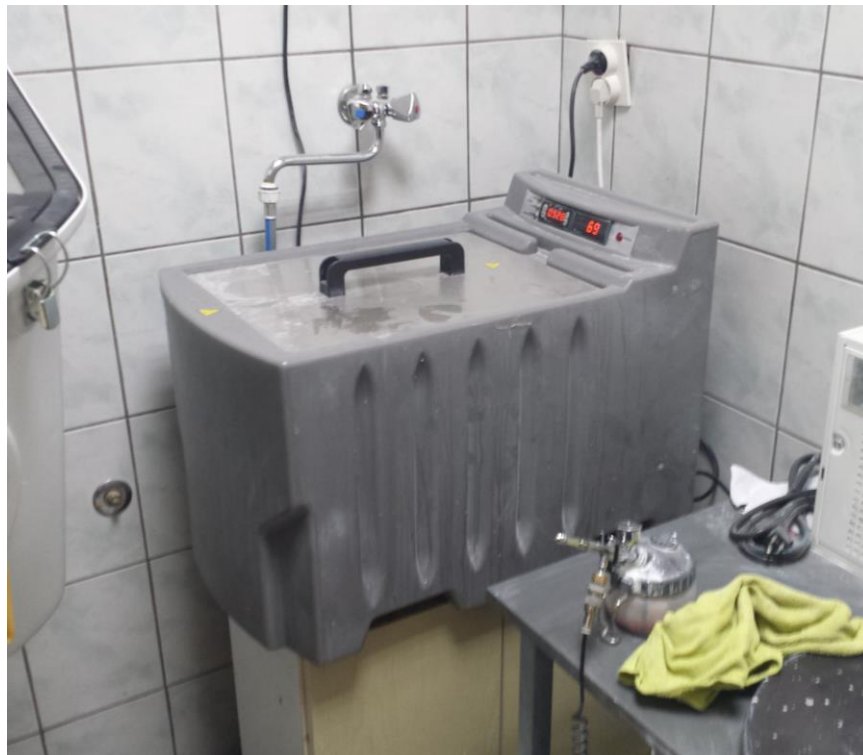
Slika 6.8 Komora za otapanje pomoćnog materijala
