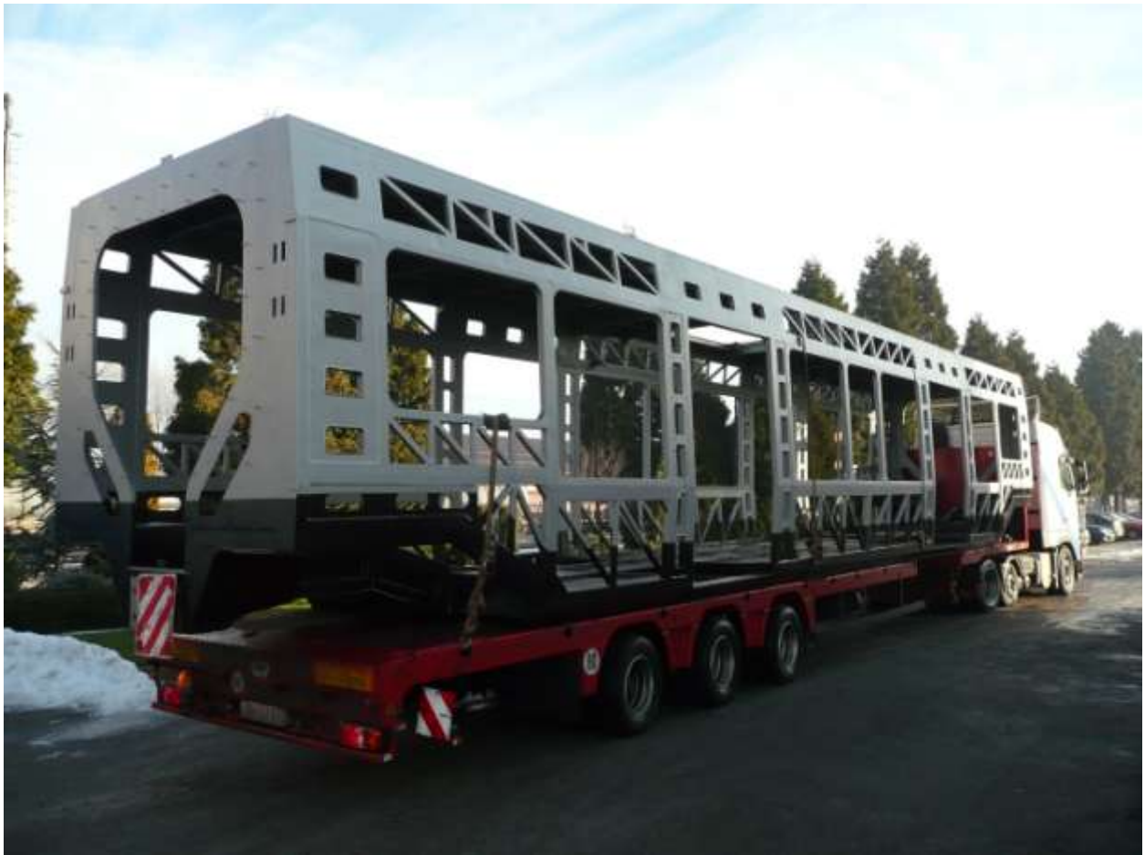
Slika 6.22 Konačna konstrukcija vagona (Modul C)
