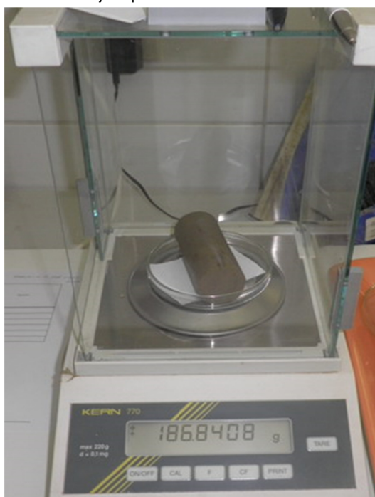
Slika 5. Ispitni uzorak izvađen iz kalupa za određivanje zapremine težine
