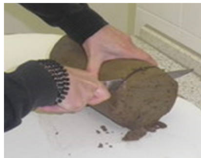
Slika 2. Rezanje reprezentativnog dijela
