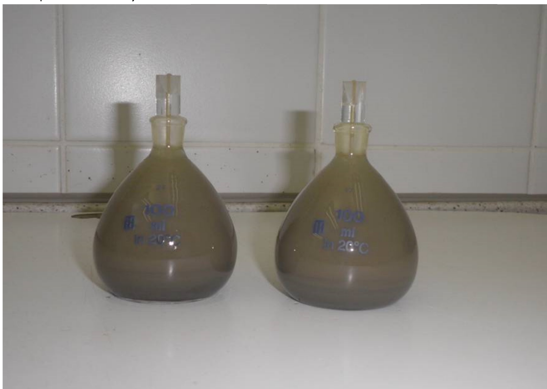
Slika 4. Ohlašeni piknometri s materijalom na 20°C
