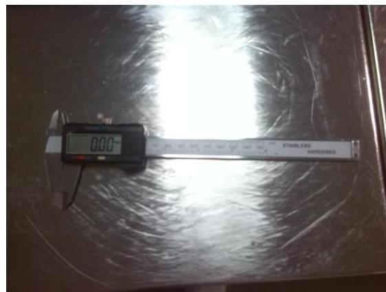
Slika 10: Pomična mjerka za mjerjenje dužine tijela i kapica kapsula
