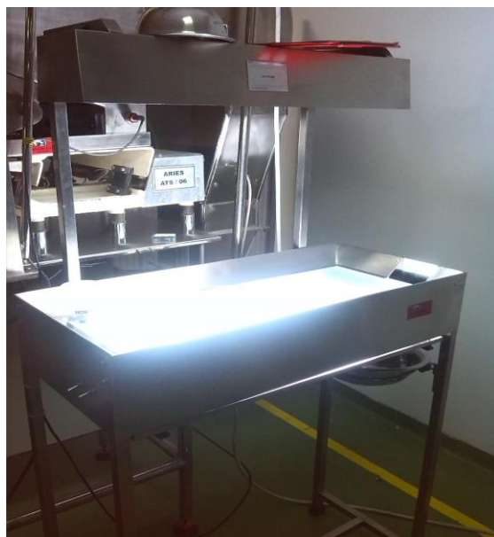
Slika 17: Inspekcijski stol za pregled kapsula
