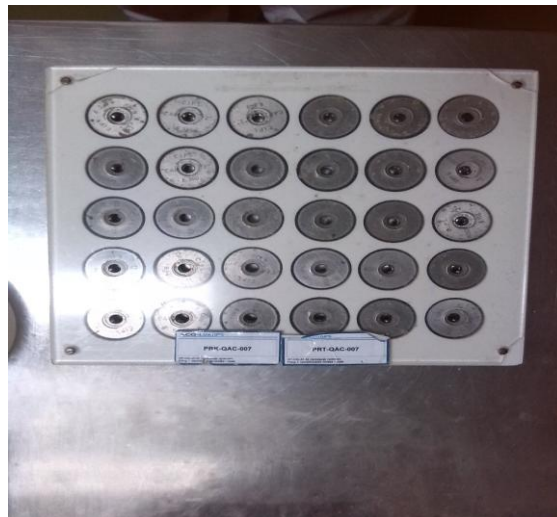
Slika 8: Pribor za mjerenje vanjskog promjera kapsula
