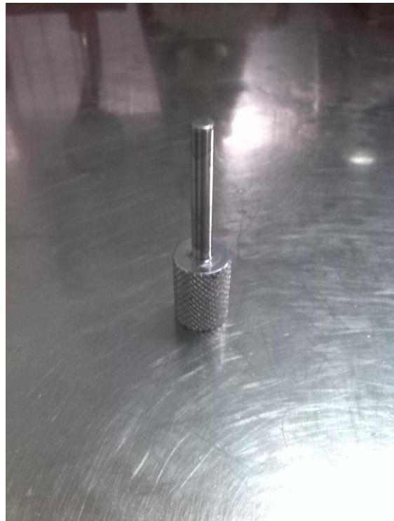
Slika 9: Uteg za mjerjenje vanjskog promjera kapsula
