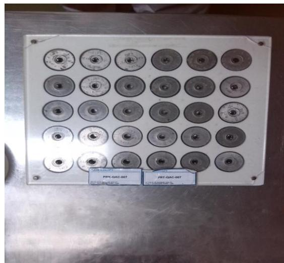
Slika 8: Pribor za mjerjenje vanjskog promjera kapsula
