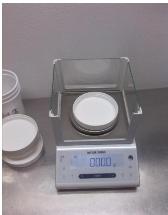
Slika 15: Digitalna vaga za mjerjenje masa kapsula
