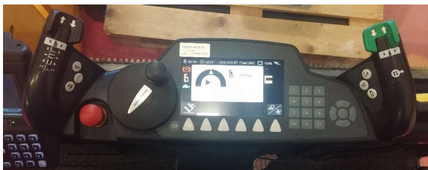
Slika 4.13 Upravljačka ploča Jungheinrich EKX 410
