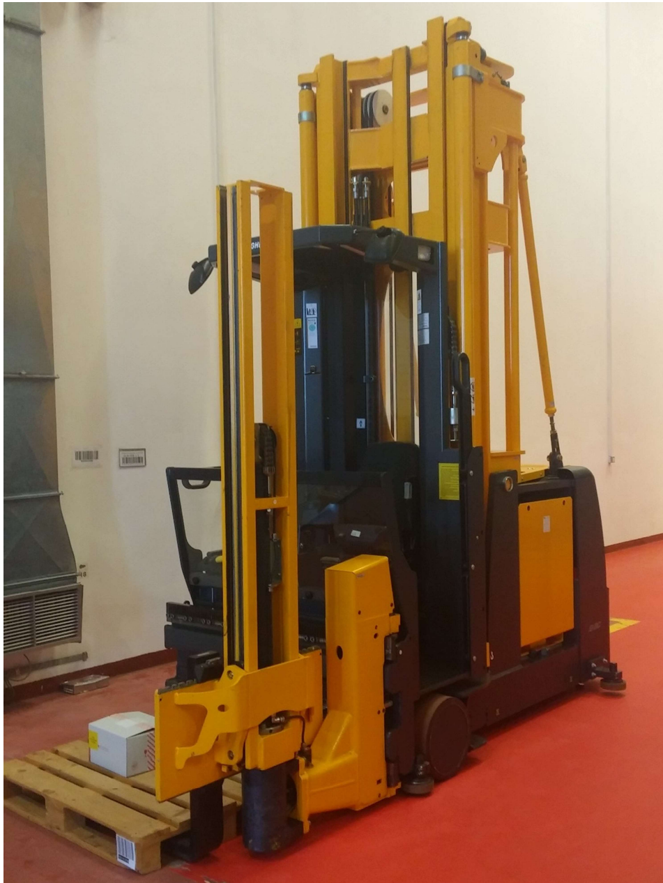
Slika 4.12 Visokoregalni viličar Jungheinrich EKX 410
