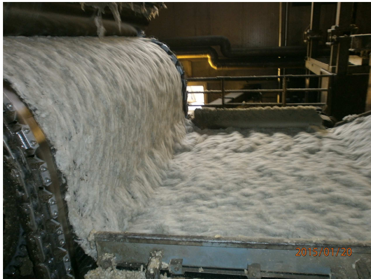
Slika 2.4: Formiranje primarnog plasta [8]
