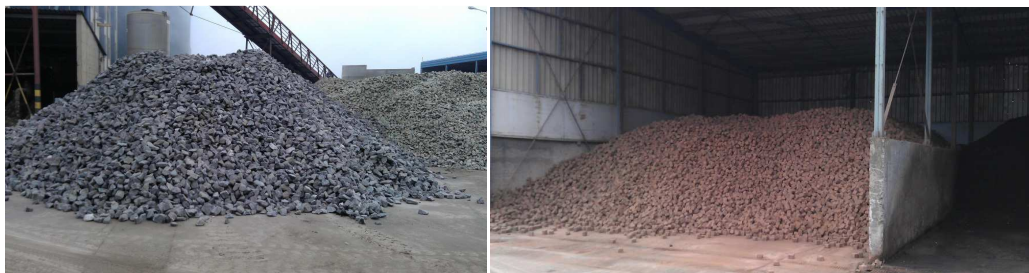
Slika 2.1: Sirovine za proizvodnju kamene vune [8]
