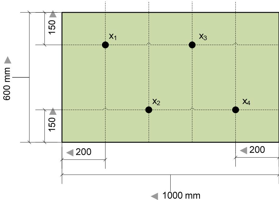
Slika 4.2 Način mjerjenja uzorka [10]
