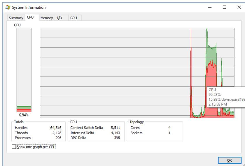
Slika 5.5. Opterećenje procesora za obradu 100 zahtjeva klijenata
