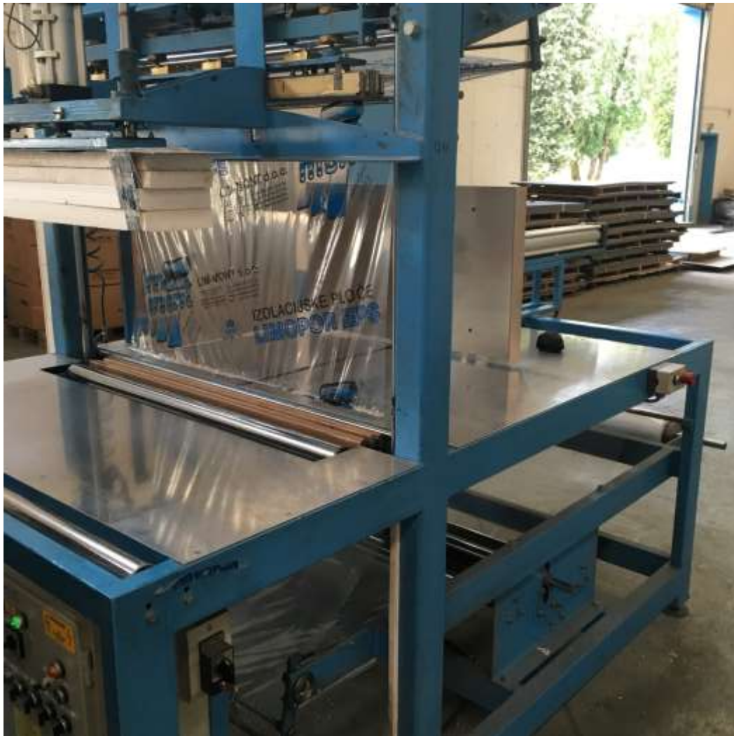
Slika 4.16 Stroj za pakiranje izrezanih ploča stiropora
