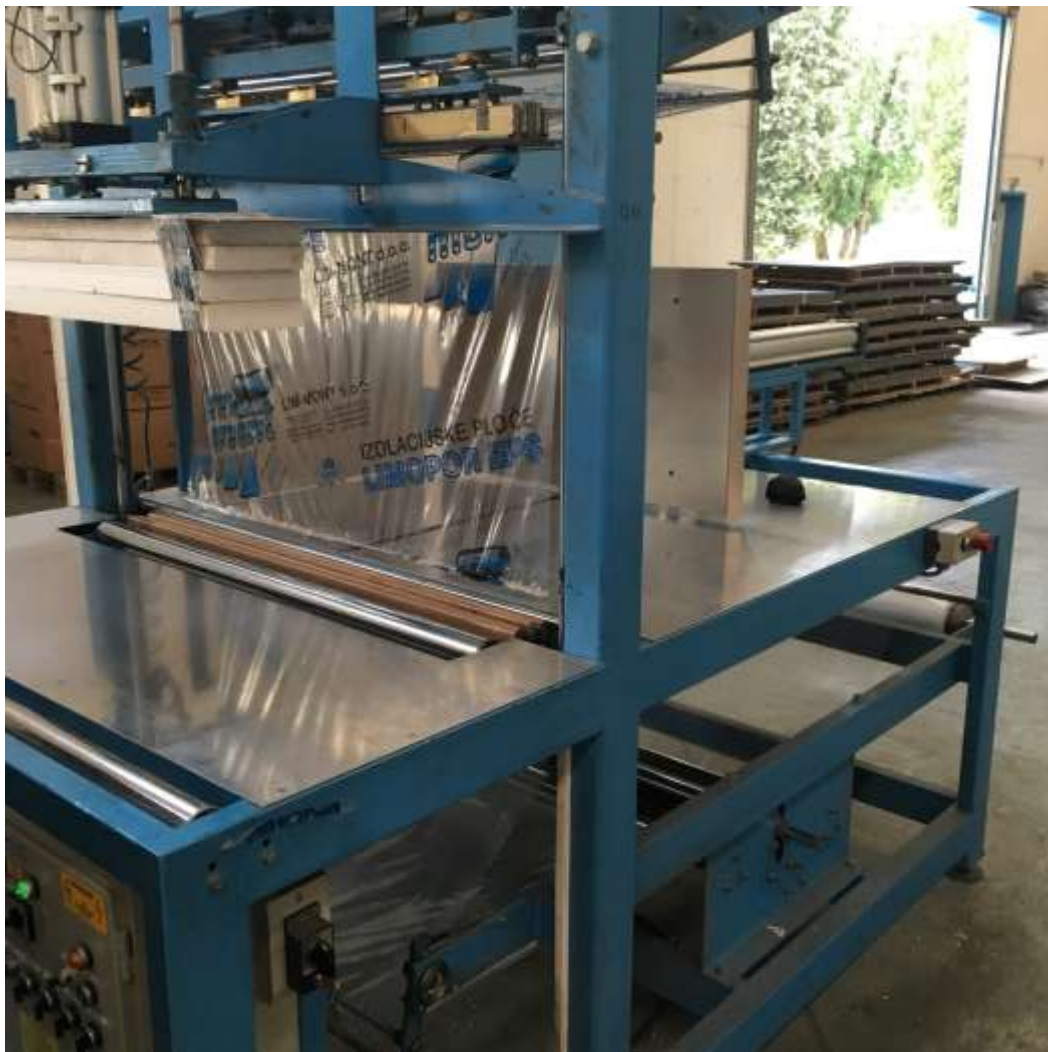
Slika 4.16 Stroj za pakiranje izrezanih ploča stiropora
