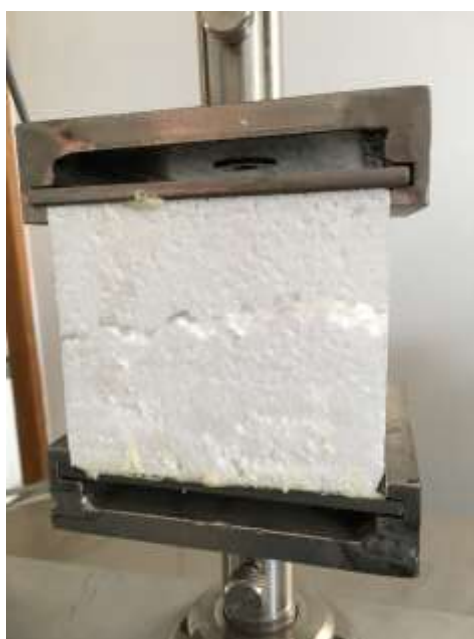
Slika 4.26 Ispitivanje vlačne čvrstoće
