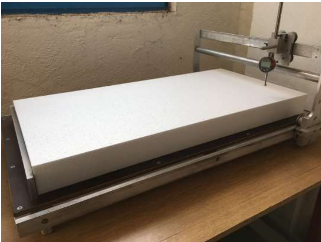
Slika 4.20 Uređaj za mjerenje duljine, širine, pravokutnosti i ravnosti.
