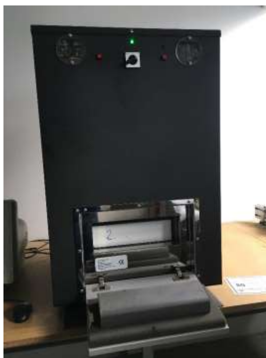
Slika 4.22 Uređaj za ispitivanje otpora prolaza topline
