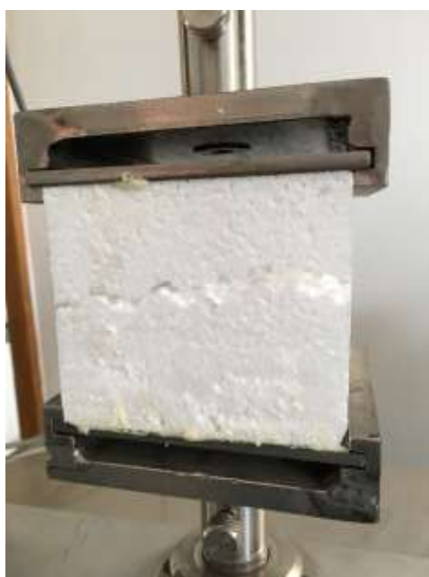
Slika 4.26 Ispitivanje vlačne čvrstoće
