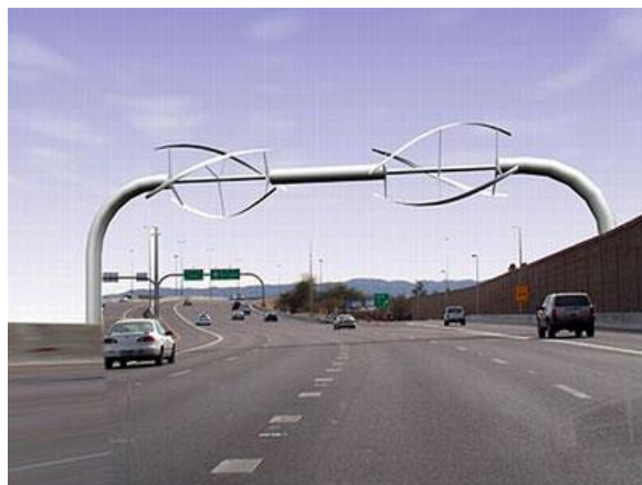
Slika 12. Horizontalna Darrieusova vjetroturbina sa spiralnim lopaticama [21]
