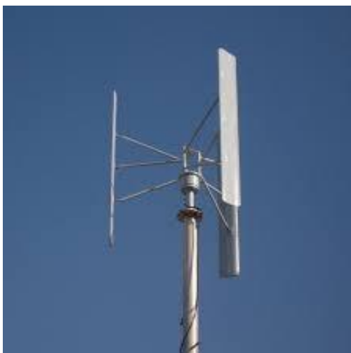
Slika 10. H-tip Darrieusove vjetroturbine [19]
