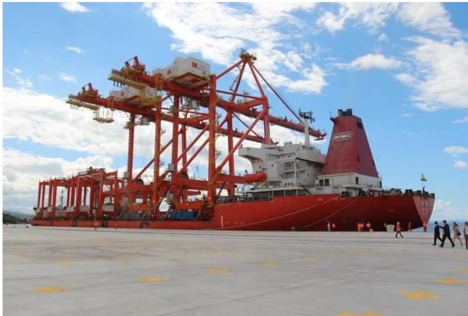
Slika 6.4.: Post Panamax kontejnerske dizalice marke ZPMC [31]
