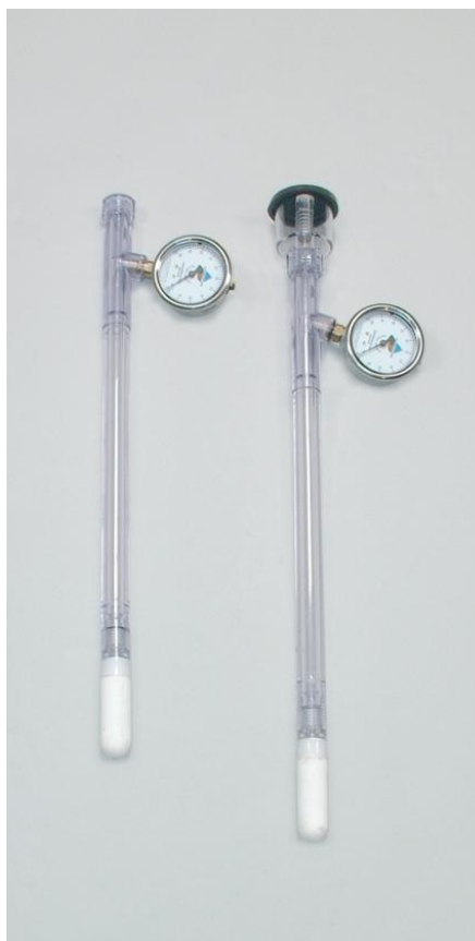
Slika 5.9 Tenzometri za namakanje
