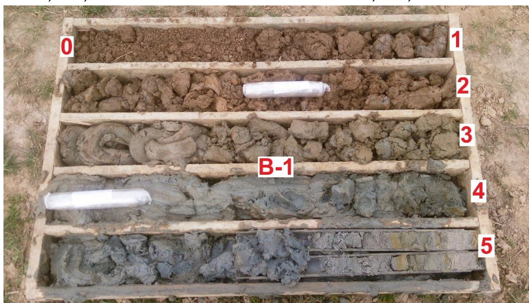
Slika 8.17 Jezgra sondažne bušotine B1
