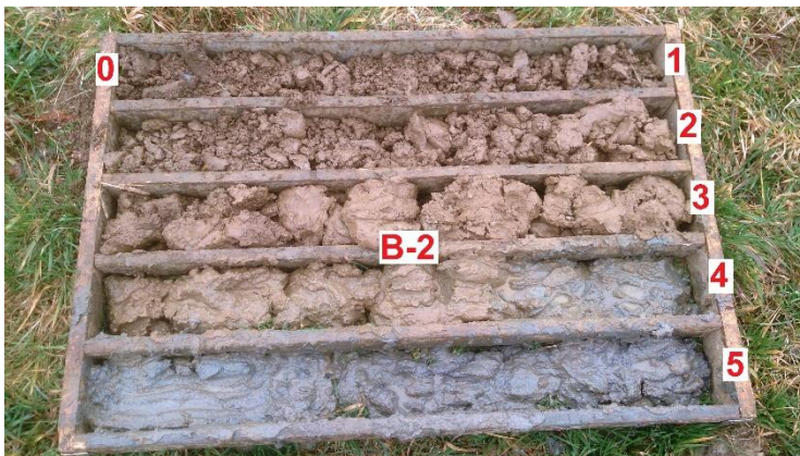
Slika 8.18 Jezgra sondažne bušotine B2
