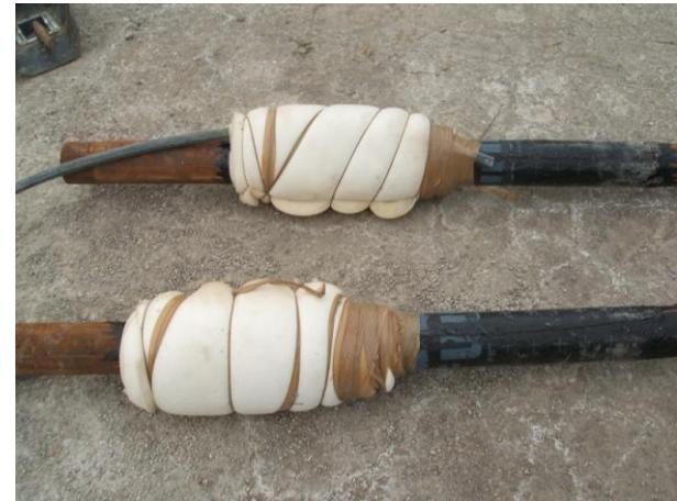
Slika 5.23. Brtva sa spojem čelične i okiten cijevi
