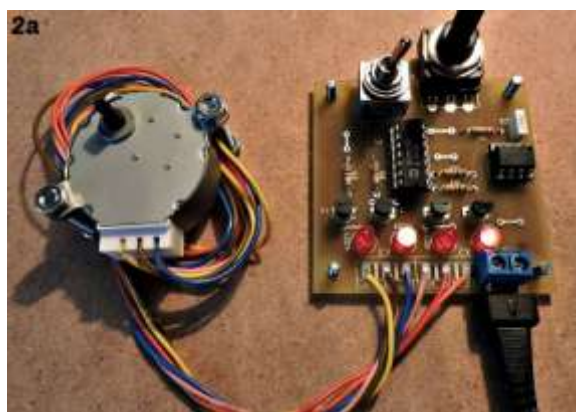
Slika 17. Sklop za upravljanje brzinom vrtnje unipolarnog koračnog motora; motor se okreće sporo
