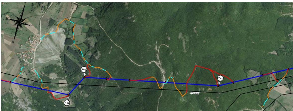
Slika 5.2. Prikaz dijela trase između stupova 20 i 30 satelitski snimak na kojem su označeni bojama pristupni putevi do pojedinog stupa<sup>56</sup>
