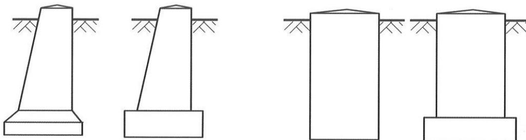
Slika 3.11. Mogući oblici temelja za stup nadzemnog voda<sup>28</sup>
