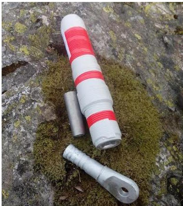
*Slika 4.8. Impulzivna spojnica*
