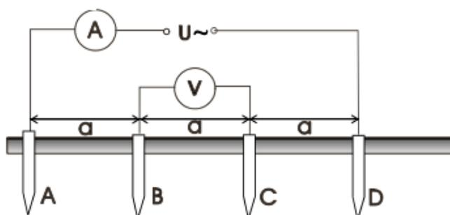
Slika 3.39. Mjerenje specifičnog otpora tla prema Wennerovoj metodi<sup>50</sup>
