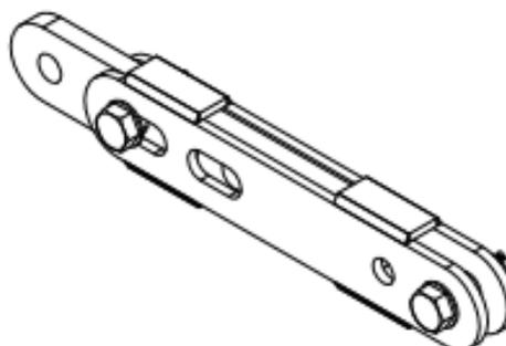
Slika 3.28. Podešavač na zateznom stupu za podešavanje
