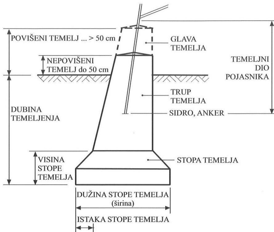
Slika 3.10. Dijelovi temelja<sup>27</sup>
