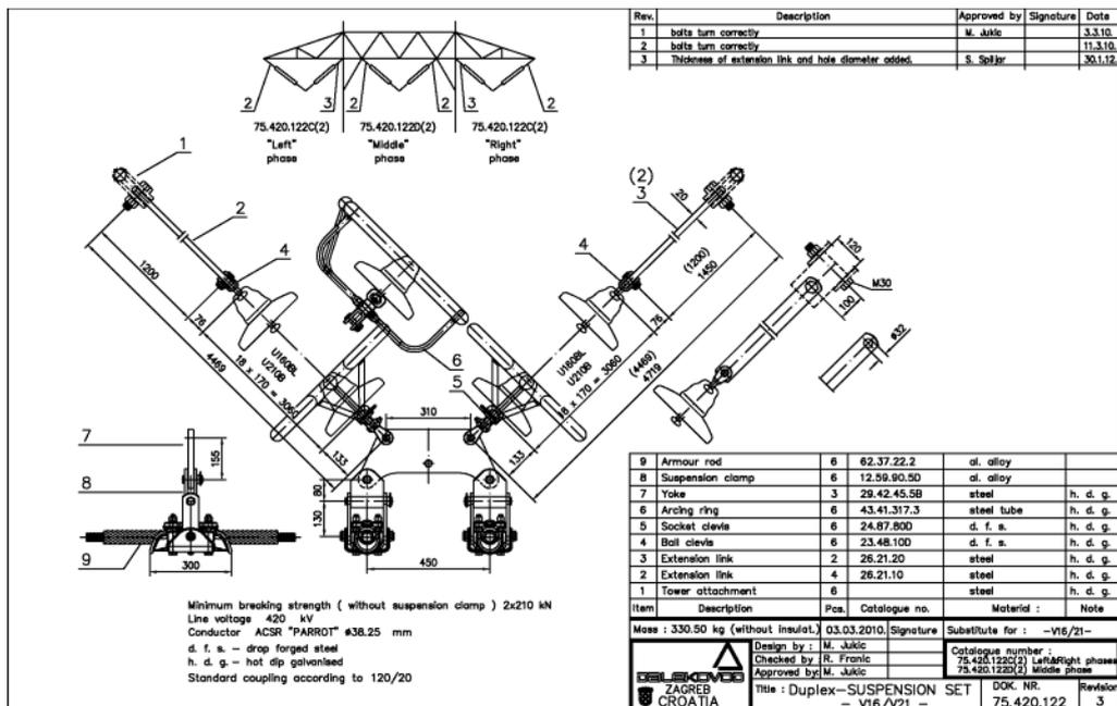
Slika 3.17. Nacrt izolatorskih V lanaca kapastih staklenih izolatora U160 i U210 sa pripadajućom ovesno spojnom opremom za nosivi stup sa dvije žice u snopu za jednu fazu (Duplex)<sup>45</sup>
