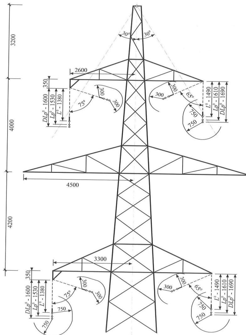
Slika 3.7. Stup „bačva“ – zaštitna zona i kutovi otklona izolatorskog lanca pri tlaku vjetra 600 (750) N/m<sup>2</sup><sup>18</sup>
