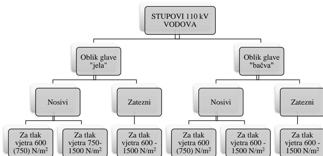
Slika 3.9. Vodovi 110 kV – grupiranje stupova<sup>20</sup>
