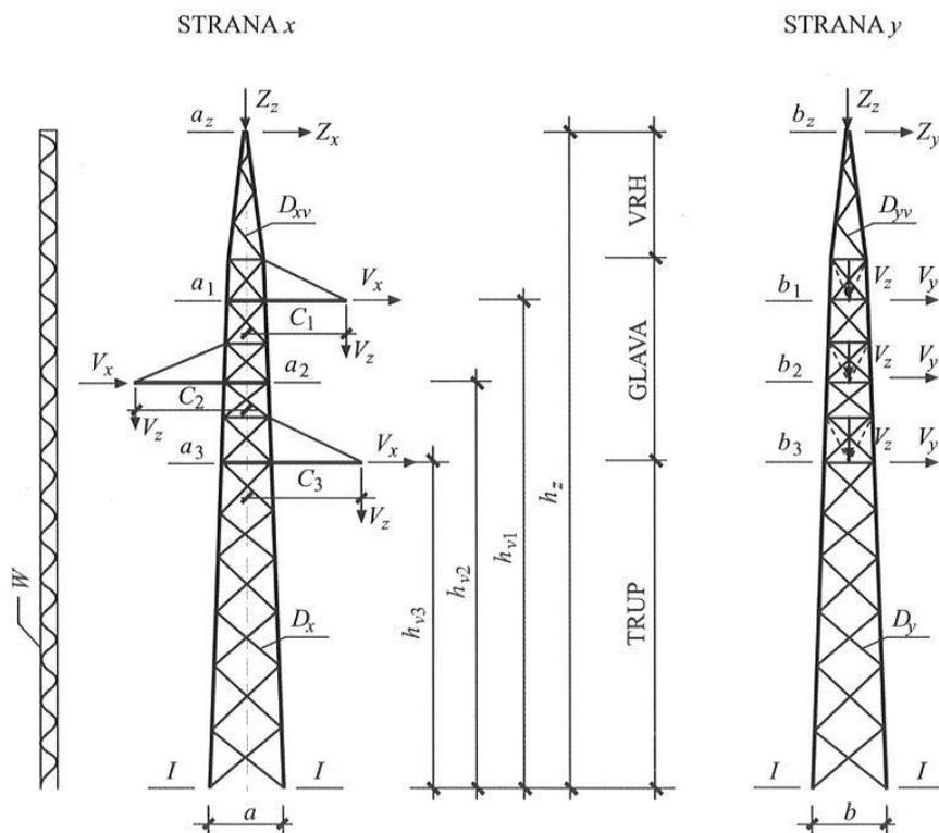
Slika 3.2. Prikaz skice stupa s opterećenjem<sup>13</sup>
