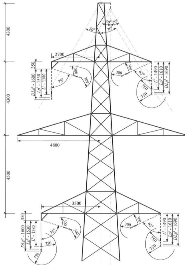
Slika 3.8. Stup „bačva“ – zaštitna zona i kutovi otklona izolatorskog lanca pri tlaku vjetra 750 (1500) N/m<sup>219</sup>
