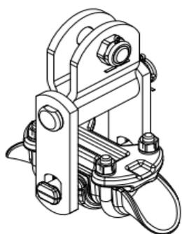
Slika 3.27. Stezaljka za vodič na nosivom stupu
