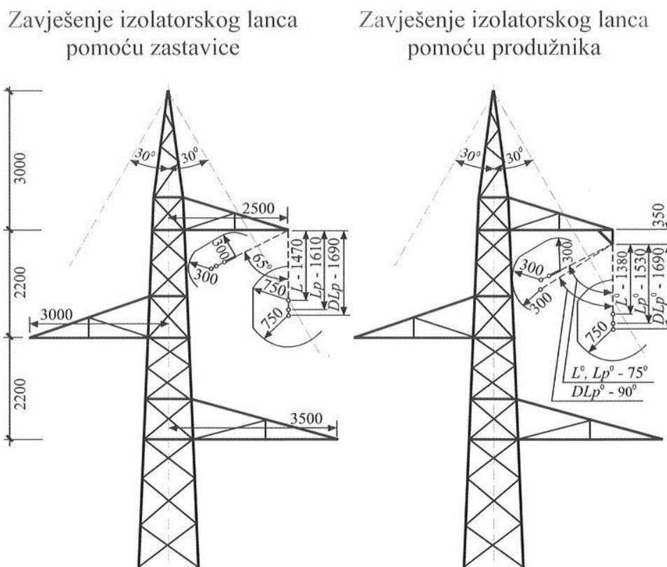
Slika 3.5. Stup „jela“ – zaštitna zona i kutovi otklona izolatorskog lanca pri tlaku vjetra 600 (750) N/m<sup>2</sup><sup>16</sup>
