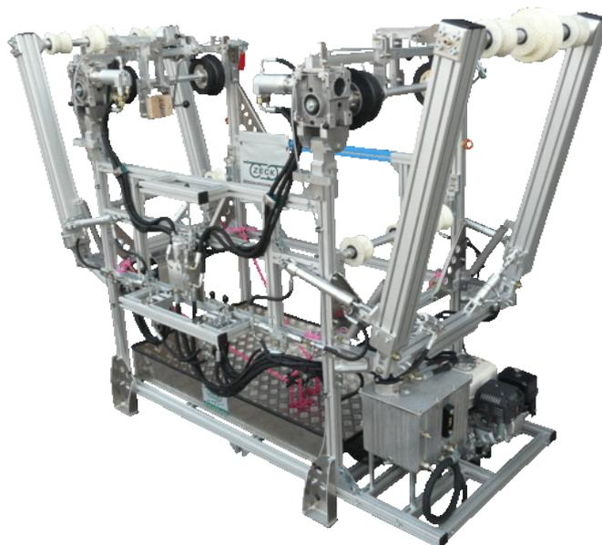
Slika 4.22. Fazna kolica za postavljanje međufaznih odstojnika
