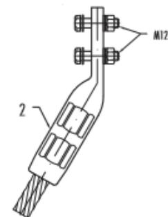
Slika 3.34. Kompresijska stezaljka za strujni most
