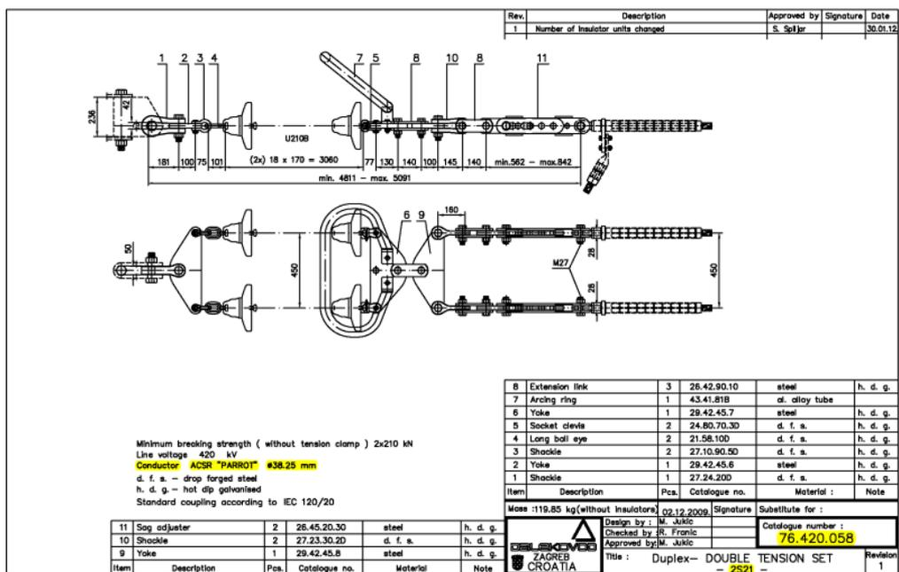
Slika 3.18. Nacrt izolatorskih lanaca kapastih staklenih izolatora U210 sa pripadajućom ovesno spojnom opremom za zatezni stup sa dvije žice u snopu za jednu fazu (Duplex)<sup>46</sup>
