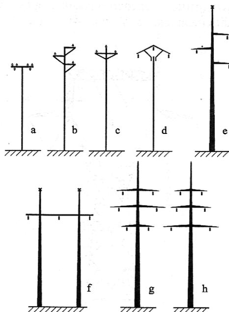
Slika 3.3. Oblici betonskih stupova<sup>14</sup>
