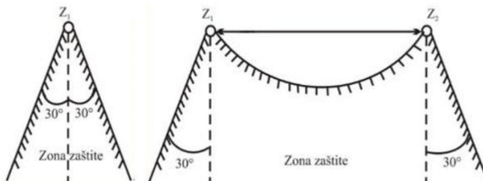
Slika 3.16. Zaštitna zona stupova s jednim i s dva zaštitna vodiča<sup>41</sup>
