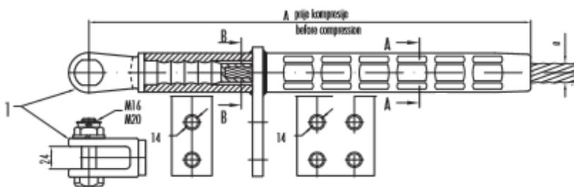
Slika 3.33. Kompresijska stezaljka za vodič na zateznom stupu
