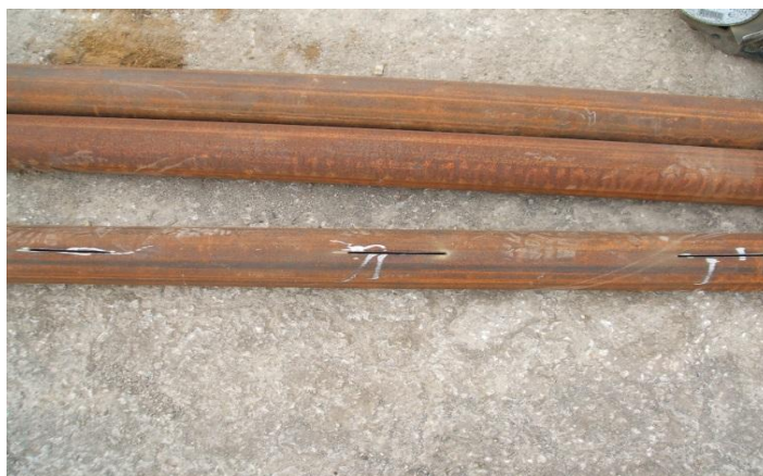
Slika 8.27: Perforiranje čelične cijevi 1,0 m od vrha cijevi
