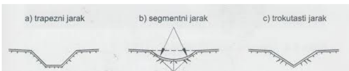
Slika 3.2: Poprečni presjeci jaraka ( Dragčević, Rukavina 2006. )
