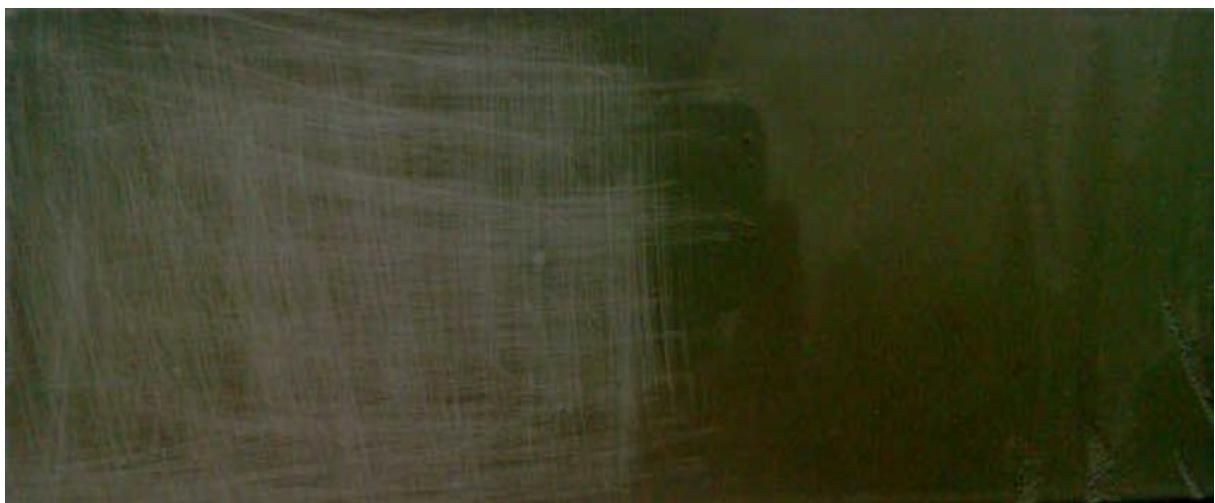
Slika 37 - Razlika između brušene i nebrušene metalne površine
