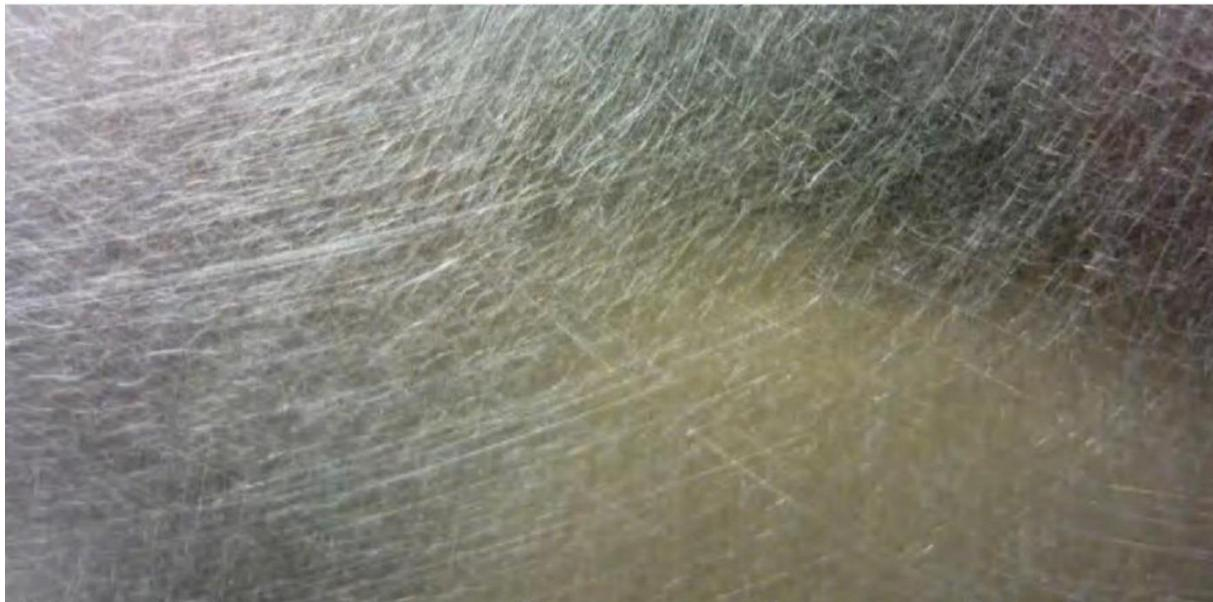
Slika 27 - Pripremljena površina - obrušeno
