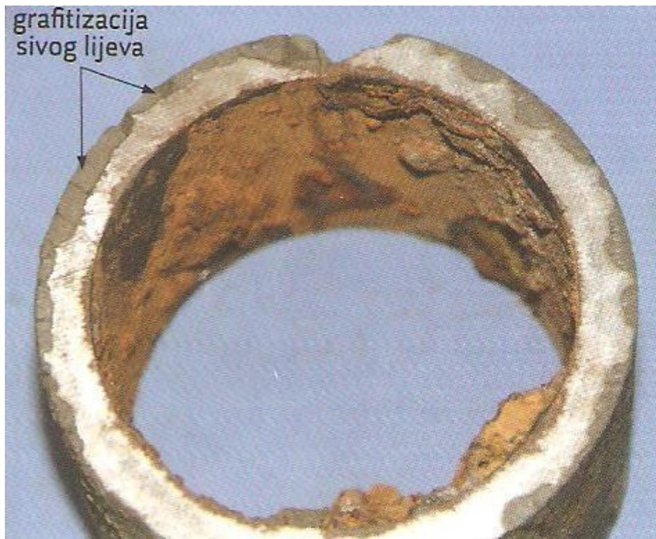
Slika 14 - Selektivna korozija vodovodne cijevi nakon 35 godina u tlu
