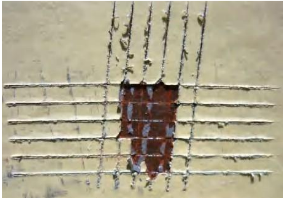
Slika 50 - Primjer loše prionjivosti
