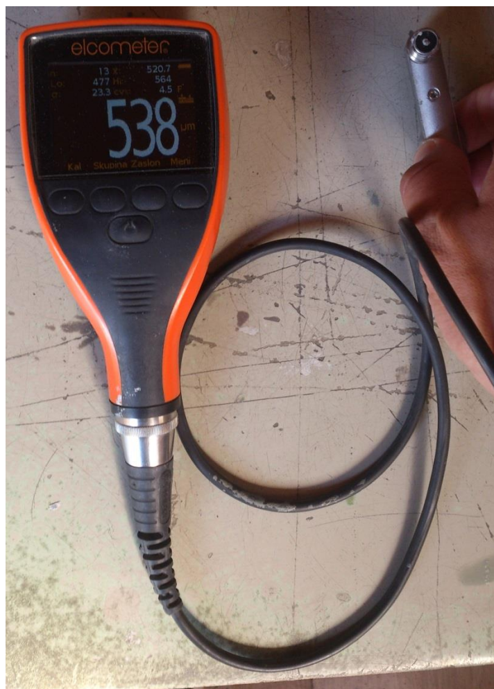
Slika 51 - Elcometer 456 – Digitalni mjerač debljine suhog filma
