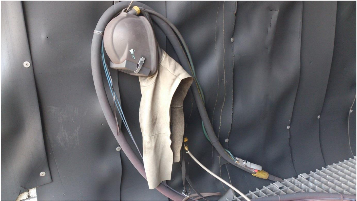
Slika 29 - Pištolj i zaštitna maska za pjeskarenje
