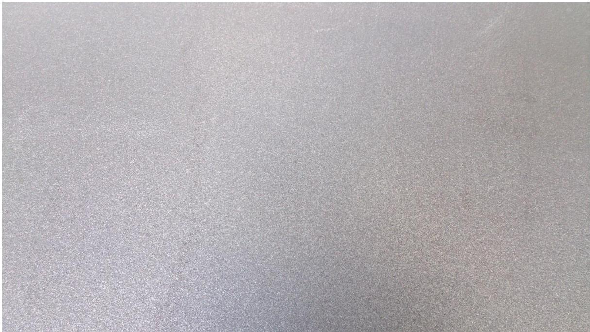
Slika 28 - Pjeskarena površina čelika
