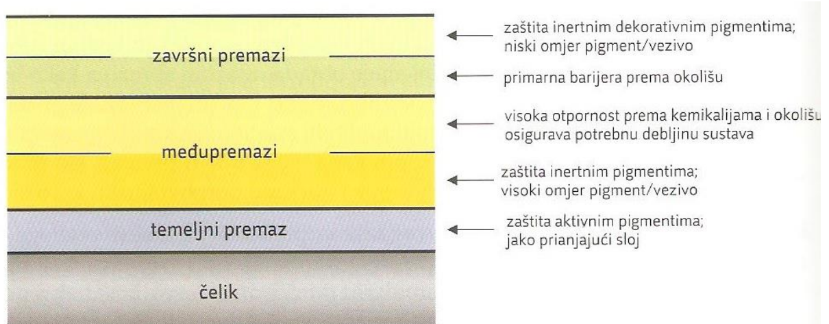
Slika 21 - Peteroslojni sustav premaza, ukupne debljine najčešće od 360 do 600 \mu\text{m}
