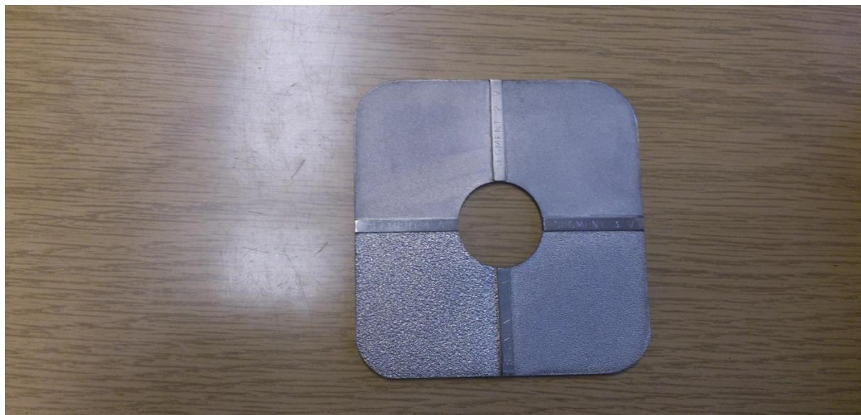
Slika 23 - Komparator za određivanje profila površine
