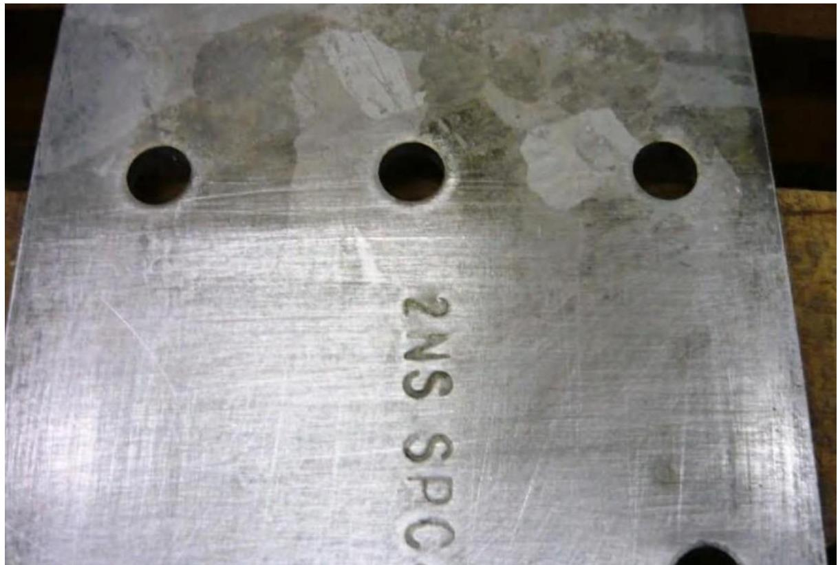
Slika 26 - Nepripremljena i pripremljena površina
