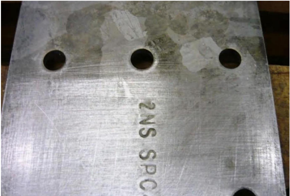
Slika 26 - Nepripremljena i pripremljena površina
