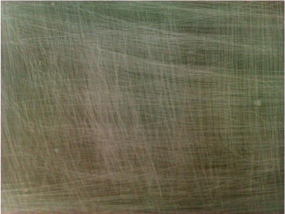
Slika 36 - Brušena / Aktivirana premazana površina (brusni papir br. 120)
