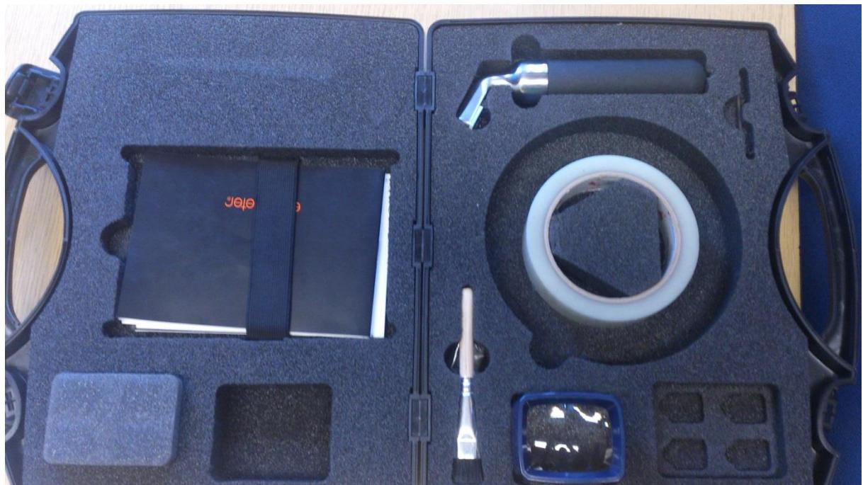
Slika 49 - Elcometer 107 - Zarezivač za provjeravanje prianjanja premaza
