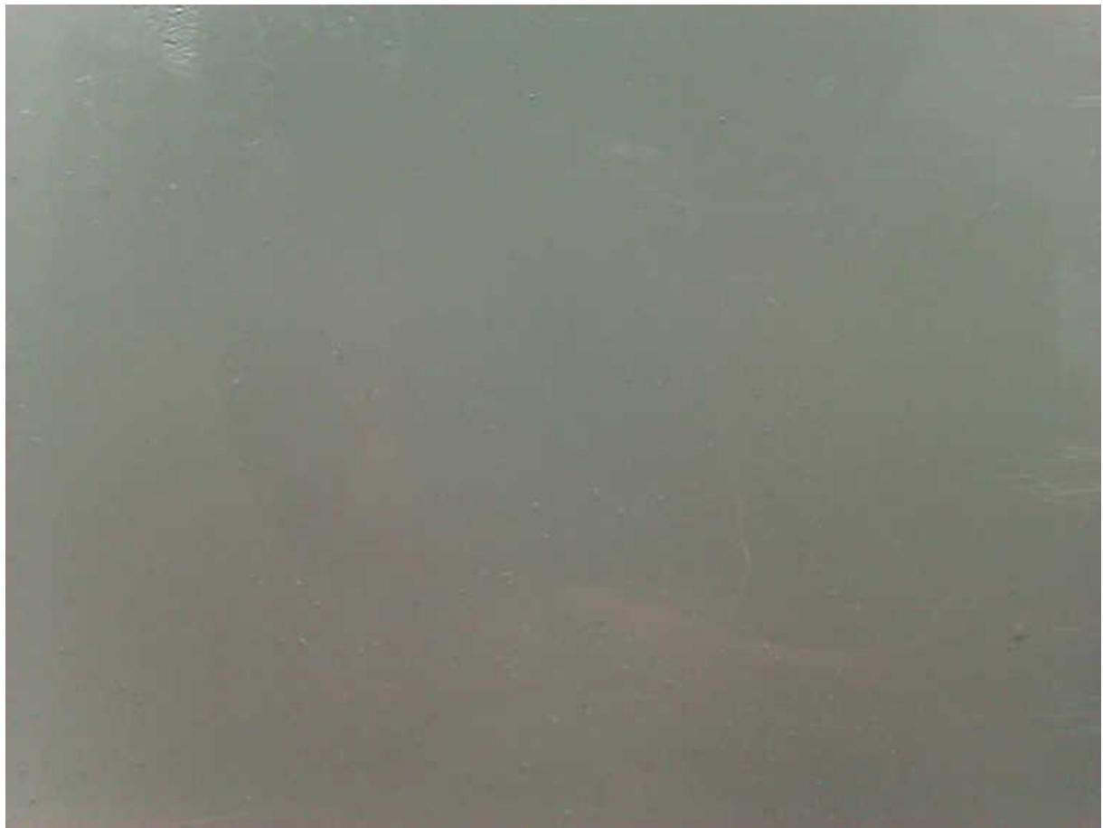
Slika 35 - Nebrušena / neaktivirana premazana površina
