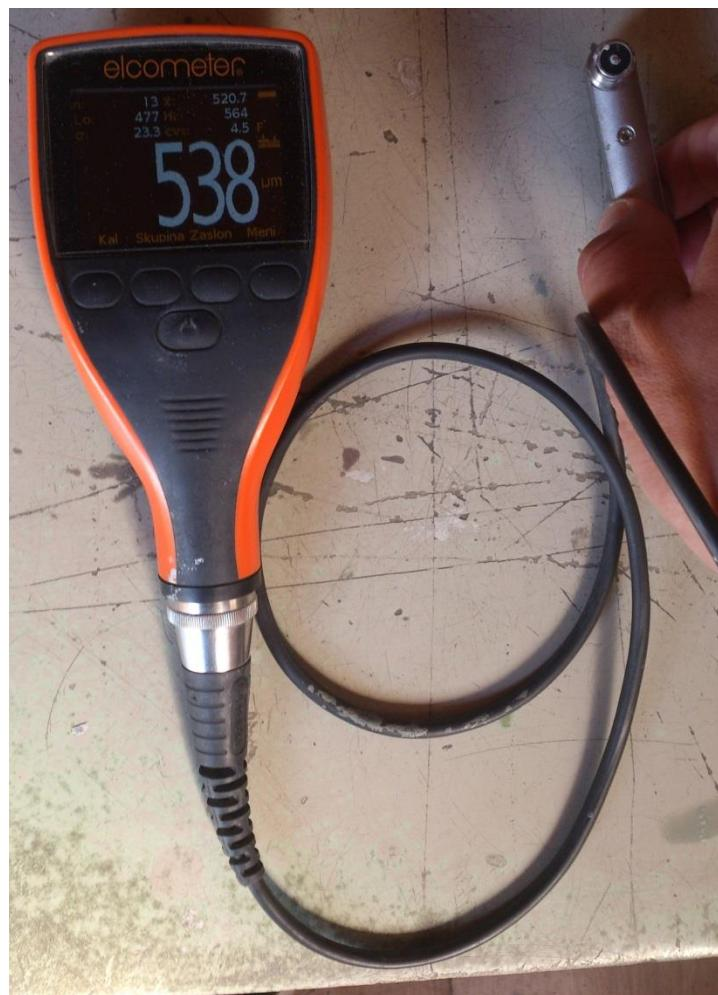
Slika 51 - Elcometer 456 – Digitalni mjerač debljine suhog filma
