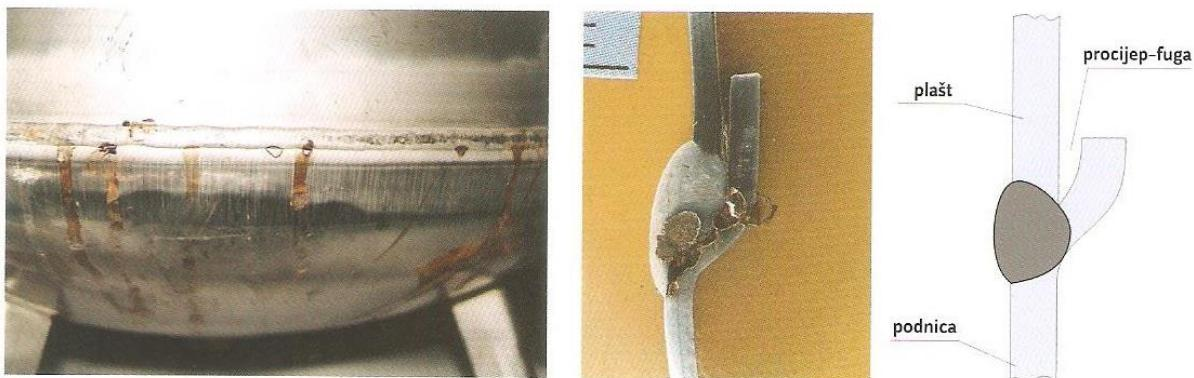
Slika 11 - Korozija u procijepu na spremniku za vodu
