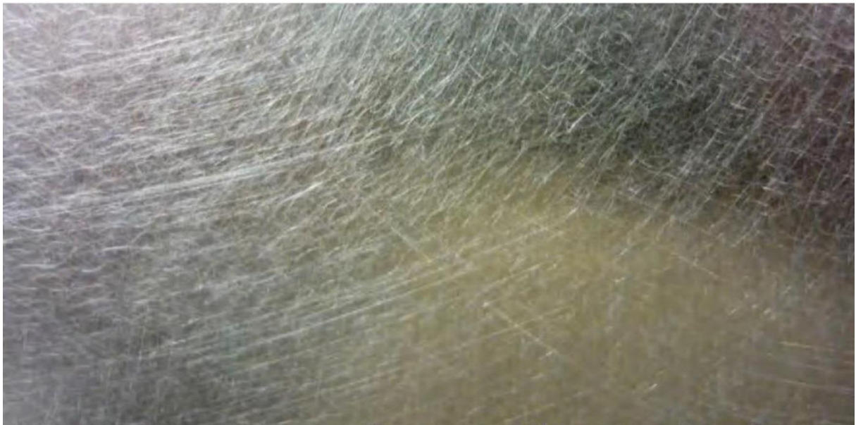
Slika 27 - Pripremljena površina - obrušeno
