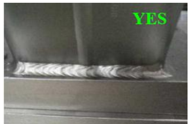
Slika 2.22 Neravnomjerna površina zavora (514) [14]
