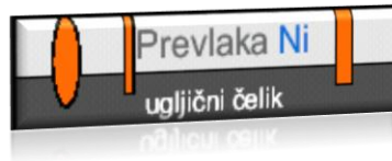
Slika 3.3. Katodna prevlaka nikla na čeliku
