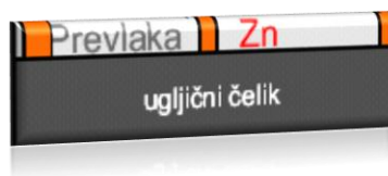
Slika 3.4. Anodna prevlaka cinka na željezu
