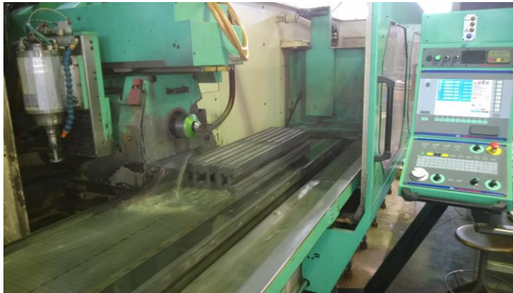
Slika 4.13 Brušenje druge bočne strane
