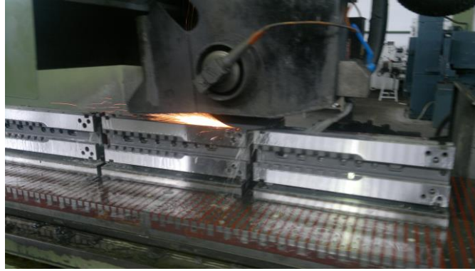
Slika 4.11 Otvaranje bočne strane
