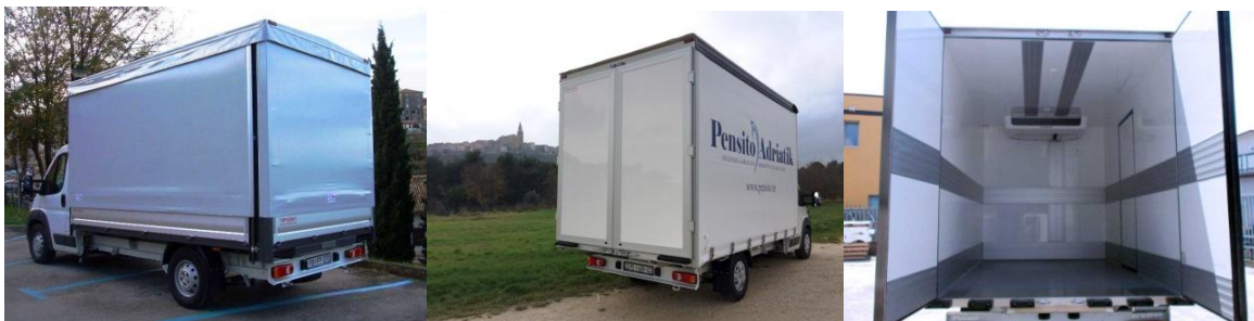
Slika 10. Konstrukcijske izvedbe nadgradnje za smještaj tereta (redosljed slika: teretni sanduk s bočnim stranicama i ceradom, zatvoreni teretni sanduk sa stražnjim vratima (alumijski), hladnjača)
