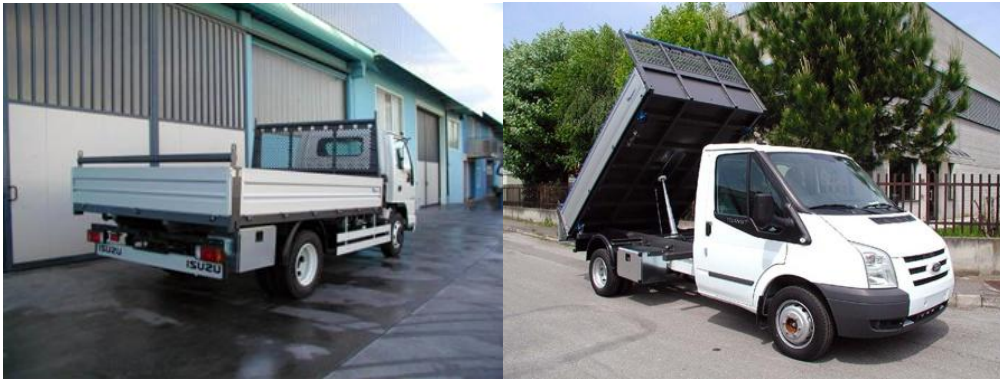
Slika 9. Konstrukcijske izvedbe nadgradnje za smještaj tereta (redosljed slika: otvoreni teretni sanduk s bočnim stranicama, kiper
