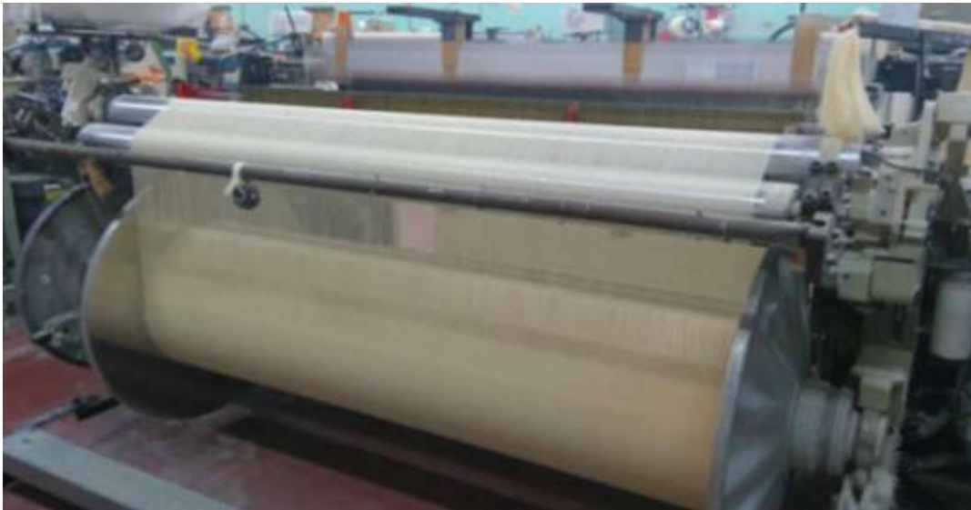
Fotografija 4.5.: Proizvodnja tkanine na tkalačkom stroju
