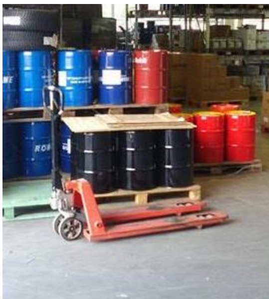
Slika 22. Ručni paletni viličar Linde M25
