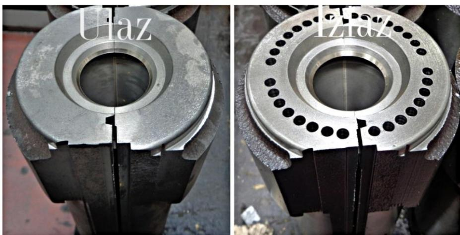
**Fotografija 10:** Duboko bušenje provrta- ulaz i izlaz
