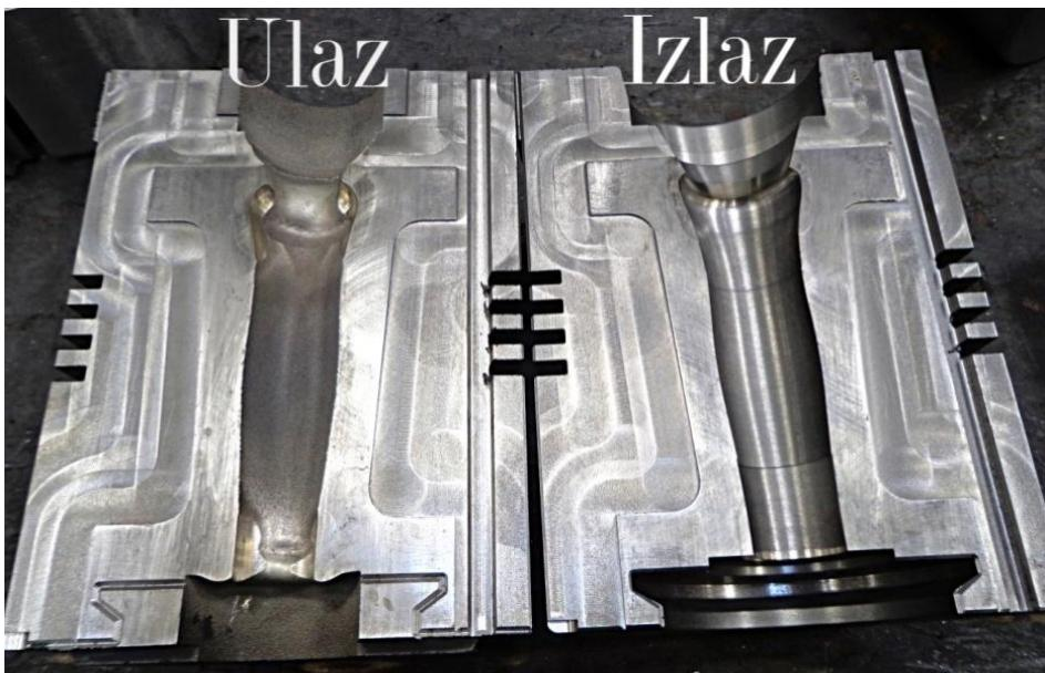
**Fotografija 8:** Unutarnje tokarenje – ulaz i izlaz
