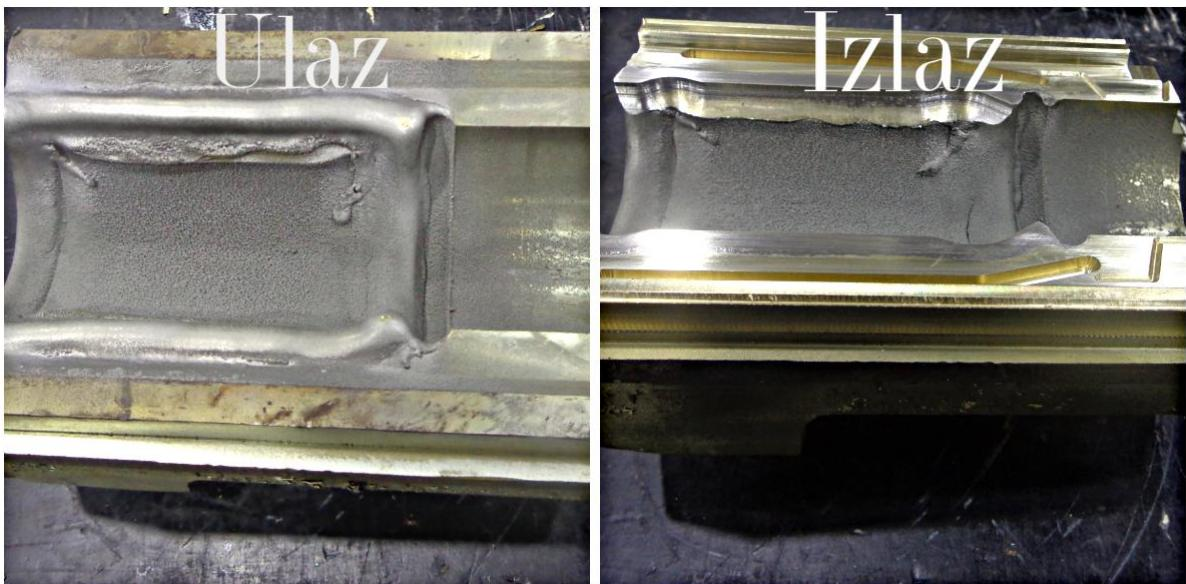
**Fotografija 6:** Glodanje nakon navarivanja- ulaz i izlaz
