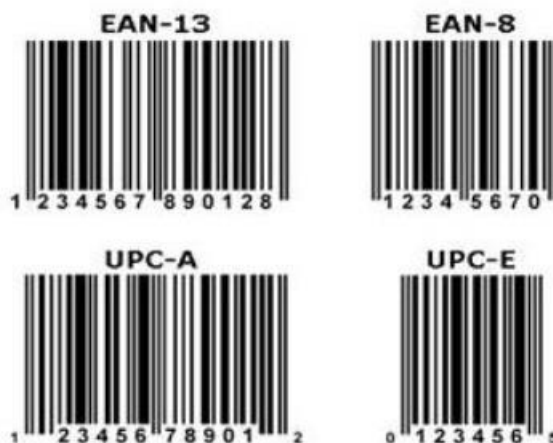
Slika 5: razlika između EAN i UPC koda (broj znamenki)
