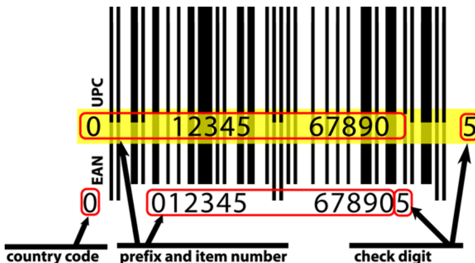
Slika 15: Struktura crtičnih kodova EAN-13 i UPC-A
