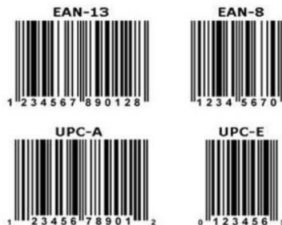
Slika 5: razlika između EAN i UPC koda (broj znamenki)
