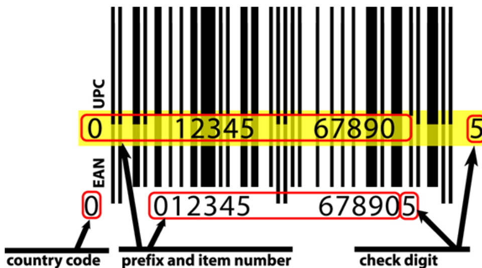
Slika 15: Struktura crtičnih kodova EAN-13 i UPC-A
