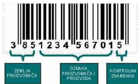
Slika 4: Oznake grupa brojeva EAN koda (EAN 13 u ovom slučaju)
