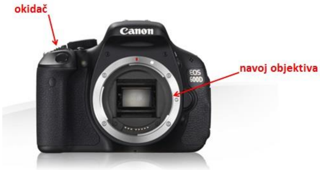
Slika 6.5 - Prikaz okidača i navoja objektiva
