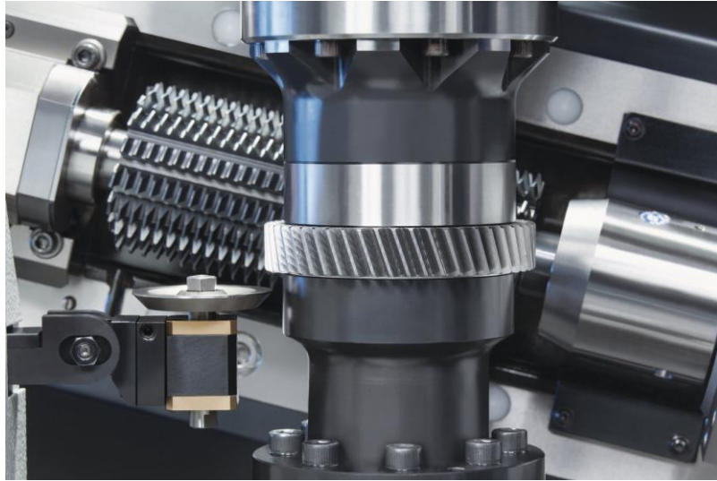
Slika 4.4 Odvalno glodanje zupčanika s kosim zubima (eng. hobbing)
