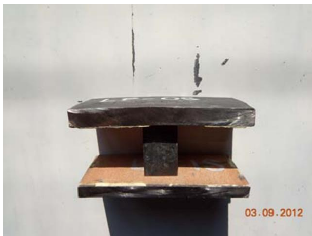
Slika 7.1 Uzorak materijala LPIS (6 x 50 x 95 mm) i LPOS (10 x 50 x 95 mm) u stvarnom stanju (Vruće strane okrenute jedna prema drugoj)
