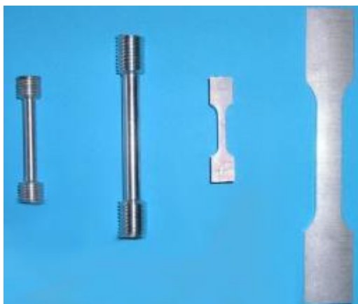
Slika 2.21 Oblici ispitnih uzorka za rastezno ispitivanje[12]
