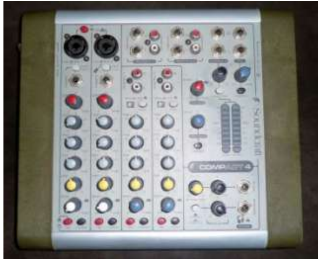
Slika 6. malo miješalo Soundcraft Compact 4 (slika preuzeta iz [9]).
