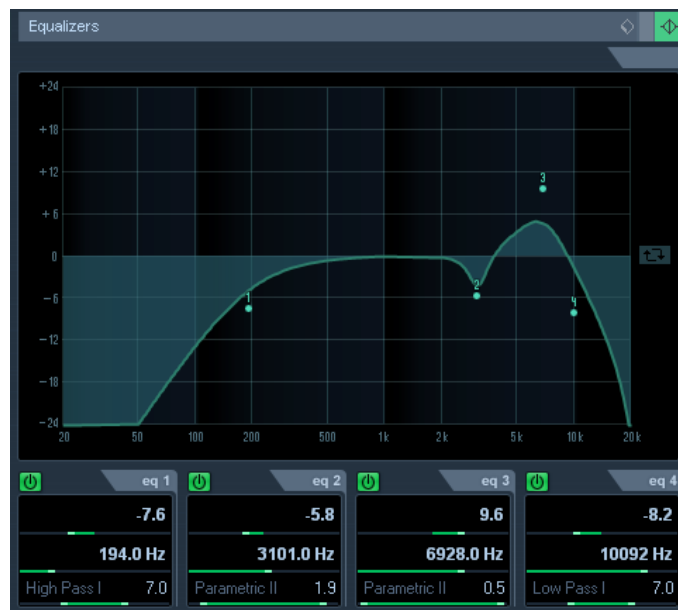
Slika 41.postavke ekvalizacije prve audio trake pick gitare.
