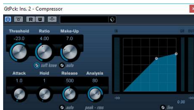
Slika 40. postavke kompresora korišten za obje audio trake pick gitare
