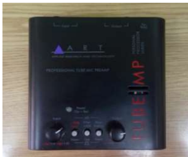
Slika 7. pretpojačalo Tube AMP tvrtke ART, koje uz tranzistorski dio ima i jednu elektronsku cijev.
