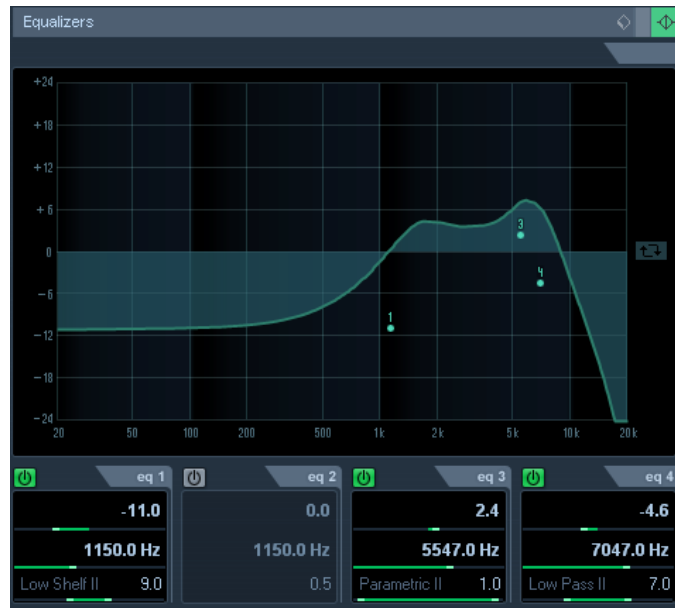
Slika 36. prikaz postavki ekvalizacije za drugu audio traku ritam gitare.
