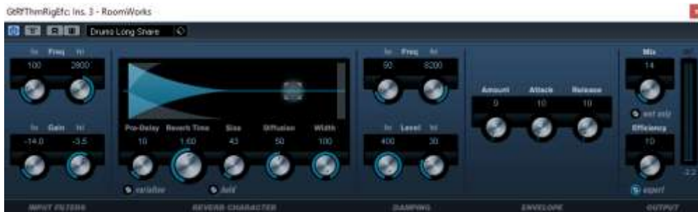
Slika 29. Room Works efekt, simulator prostorije i postavke korištene za spomenutu audio traku.
