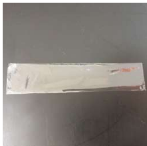
4.18 uzorak za vlačno ispitivanje čvrstoće [25]
