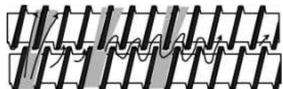
3.3 Dvopužni vijci rotiraju u istom smjeru [24]
