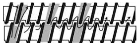
3.3 Dvopužni vijci rotiraju u istom smjeru [24]
