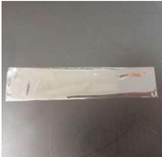
4.18 uzorak za vlačno ispitivanje čvrstoće [25]
