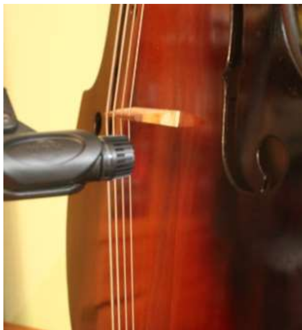
Slika 4.11 Pozicioniranje mikrofona za tamburaški bas.
