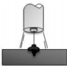
Slika 3.4. Prijenos metala kratkim spojem – shematski prikaz[6]
