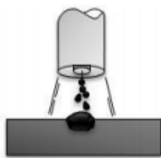
Slika 3.5. Prijenos metala mješovitim lukom – shematski prikaz[6]
