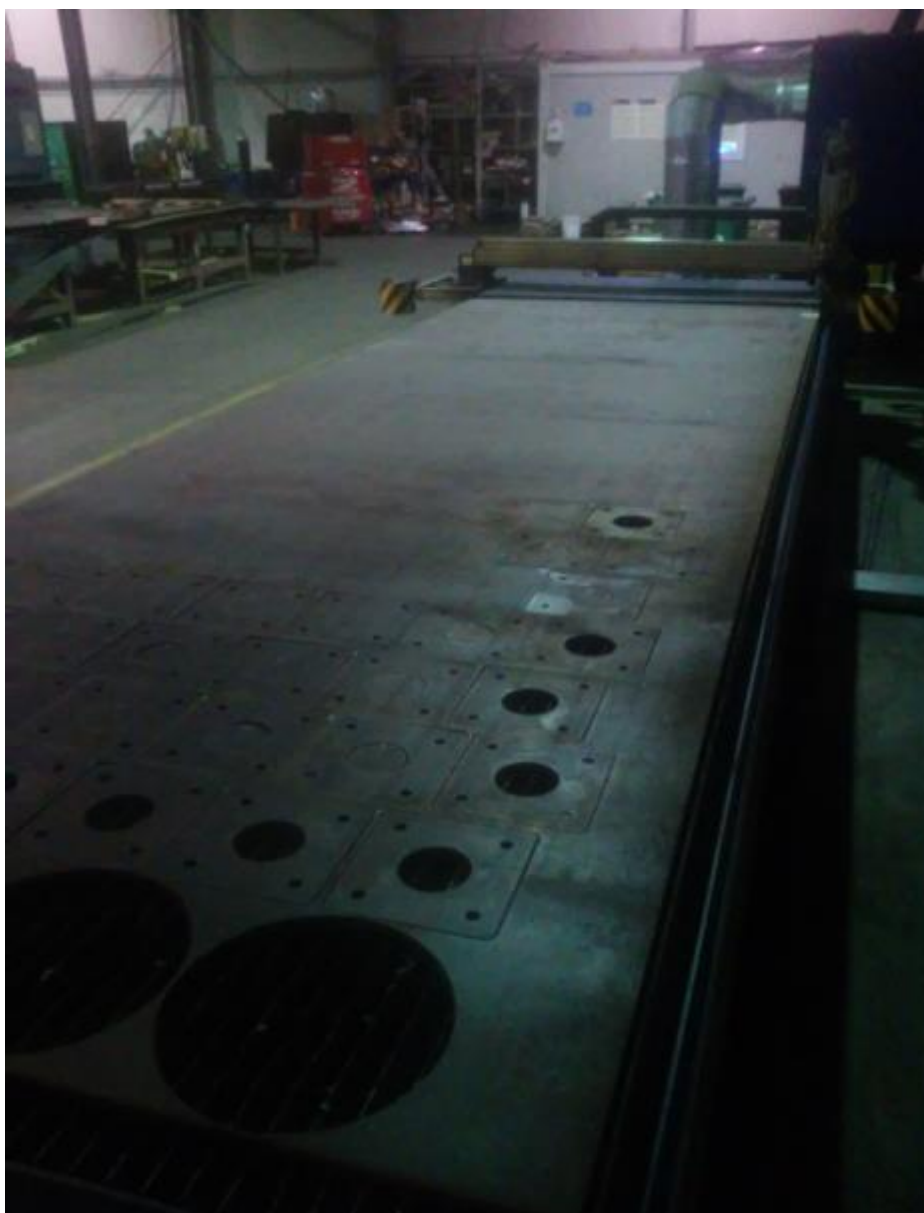
Slika 5.7. CNC plazma rezanje temeljnih ploča
