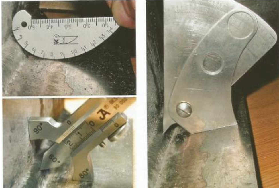
Slika 4.4 Različita pomagala za mjere – jednostavno mjerilo, mjerilo s nonijem, mjerilo s tri skale [5]
