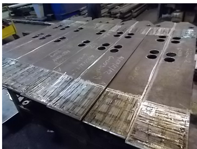
Slika 4.10 Ispitivanje pozicije 2 na slojavost
