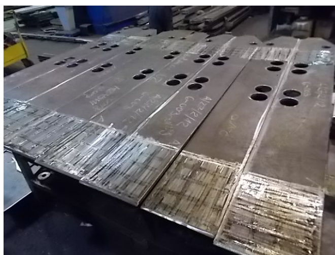
Slika 4.10 Ispitivanje pozicije 2 na slojavost
