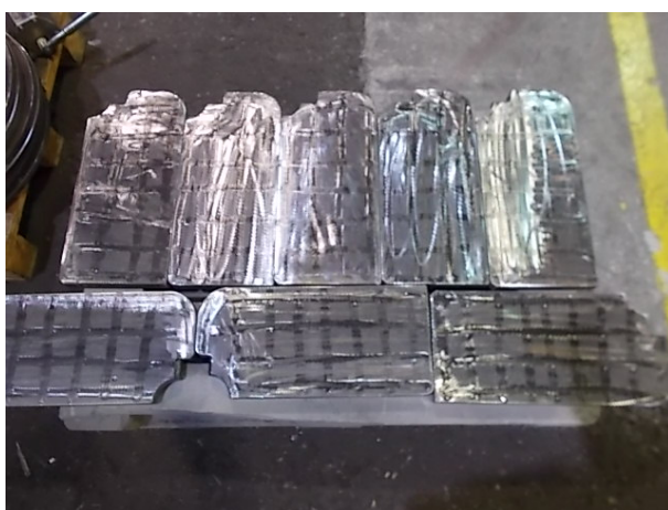
Slika 4.9 Ispitivanje pozicije 1 na slojavost
