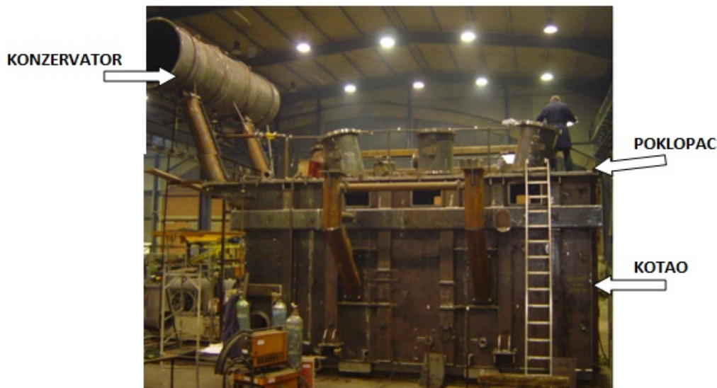
Slika 4.1 Glavni dijelovi trafokotla
