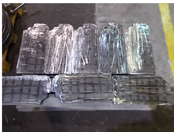
Slika 4.9 Ispitivanje pozicije 1 na slojavost
