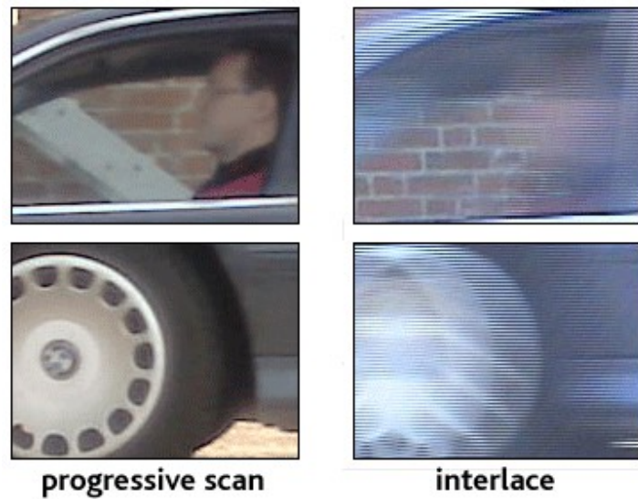
Slika 3.2 Progresivno i isprepletено snimanje
