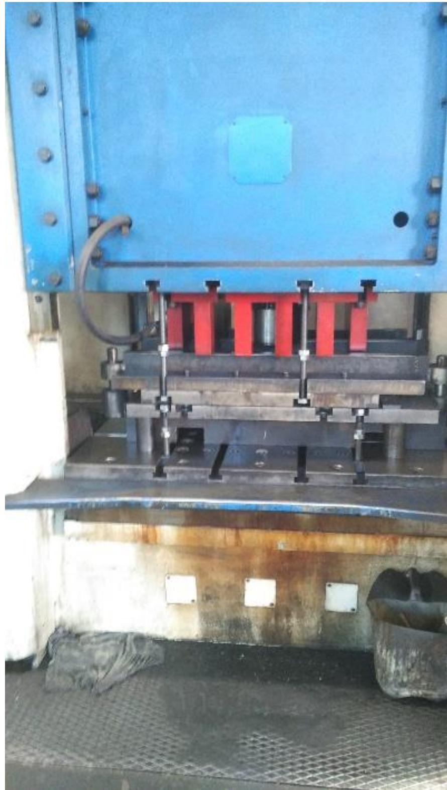
Slika 5.7 hidraulična preša za podnice
