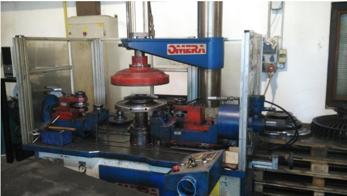
Slika 5.8 stroj za skidanje rubova
