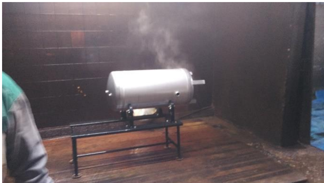
Slika 5.16 kemijsko čišćenje zavara
