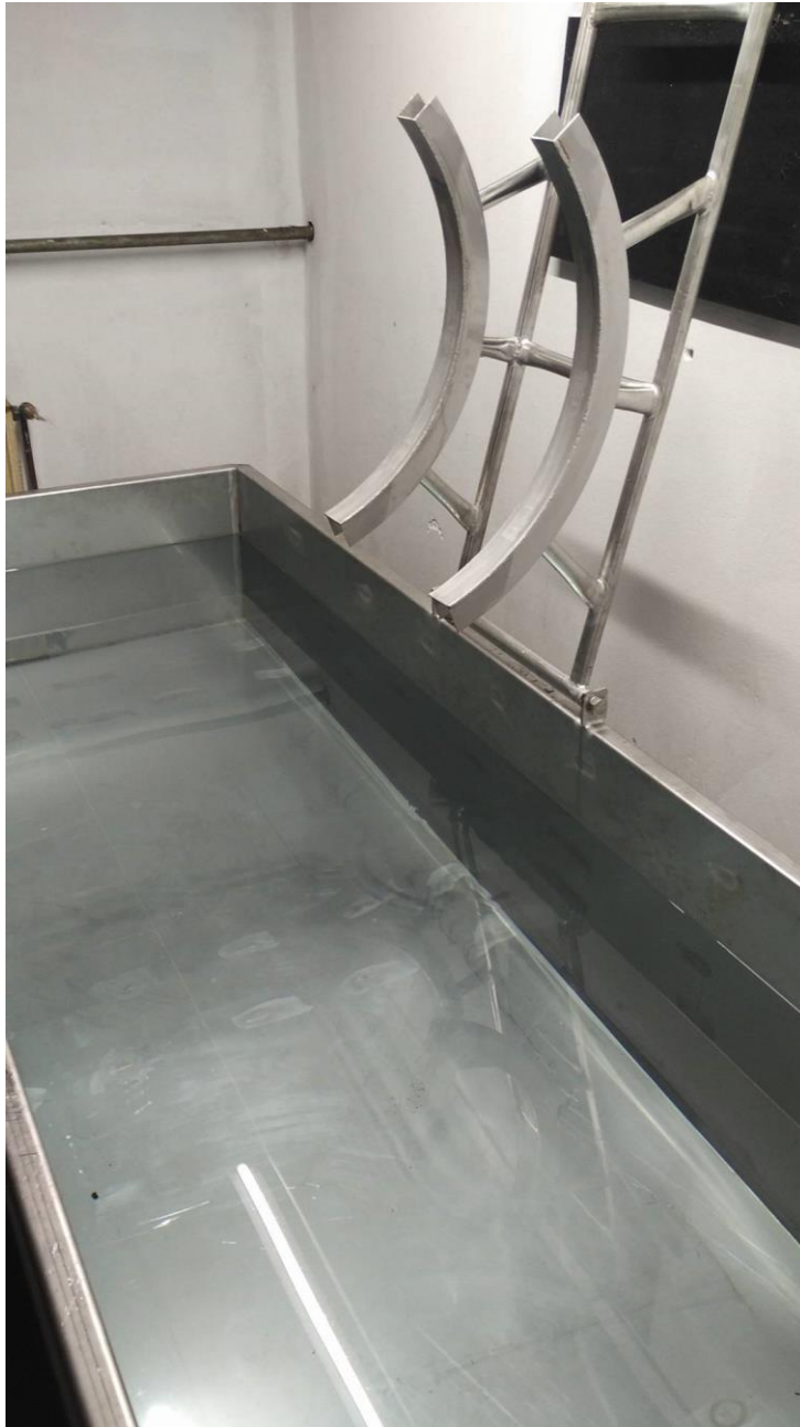
Slika 5.17 bazen za tlačnu probu
