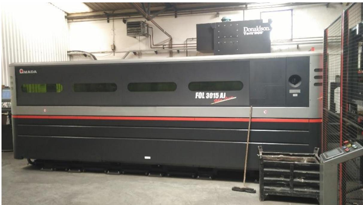
*Slika 5.6 laser za rezanje podnice*
