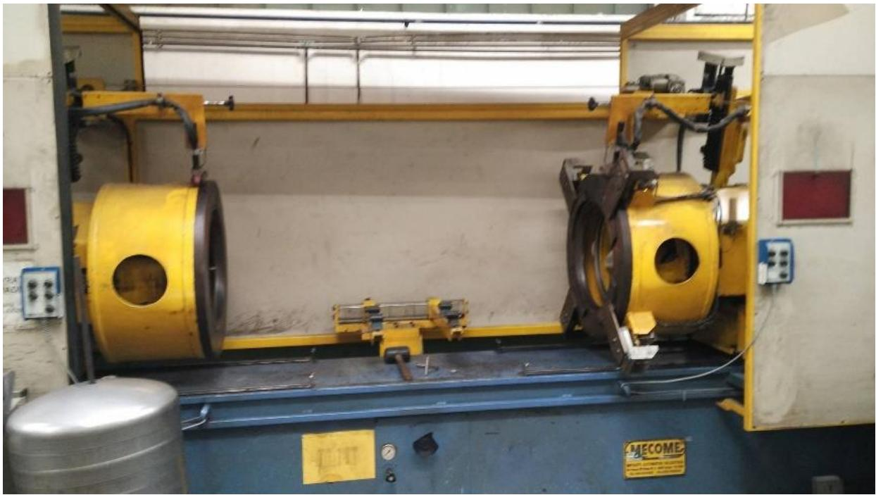
Slika 5.11 automatsko zavarivanje podnice s plaštom
