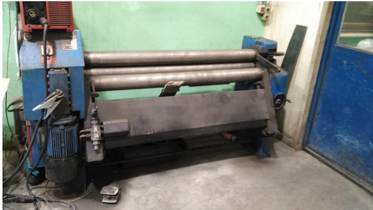
*Slika 5.3stroj za kružno savijanje*
