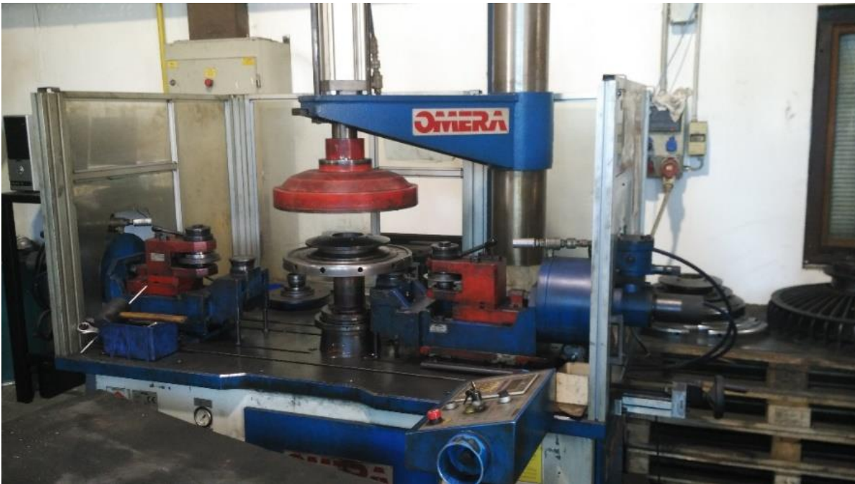
Slika 5.8 stroj za skidanje rubova
