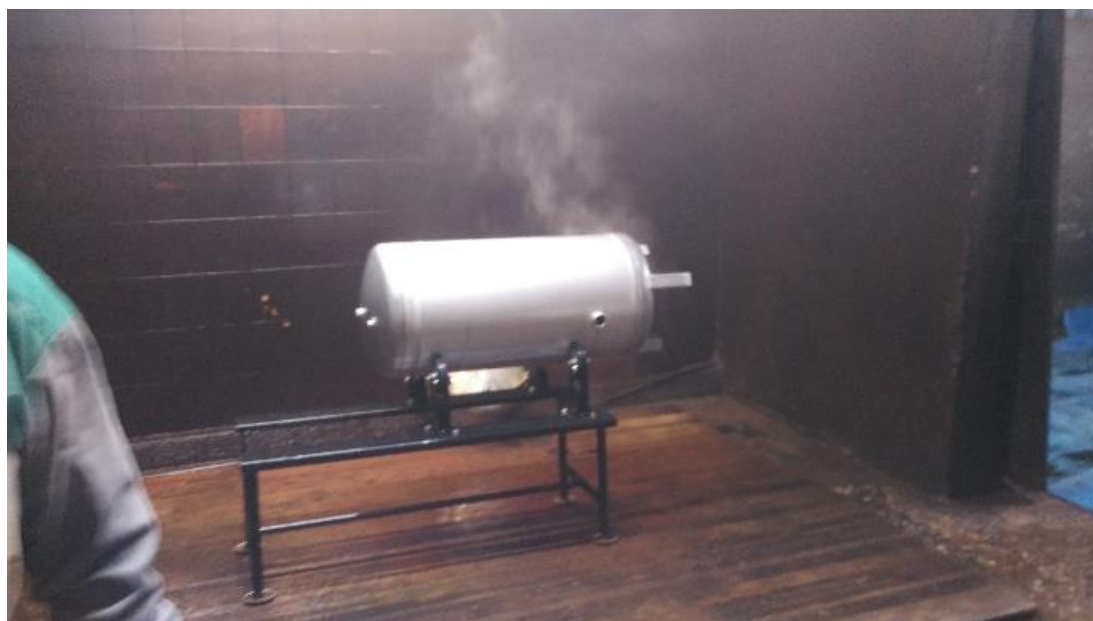
Slika 5.16 kemijsko čišćenje zavara
