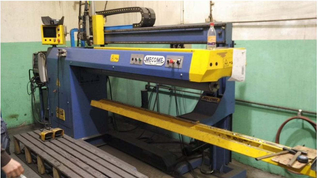
Slika 5.5 stroj za zavarivanje plašta
