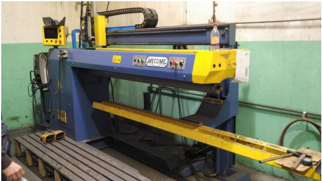
*Slika 5.5 stroj za zavarivanje plašta*
