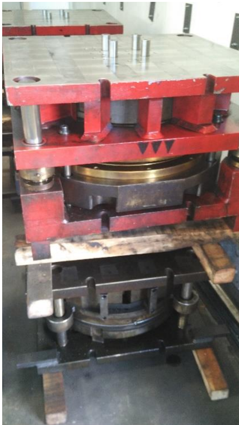
Slika 5.2 alat za probiranje rupa
