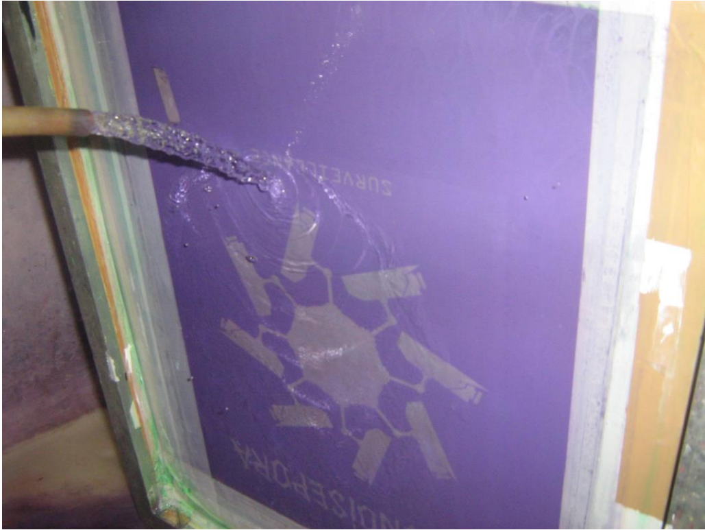
Slika 3.5. Ispiranje emulzije vodom
