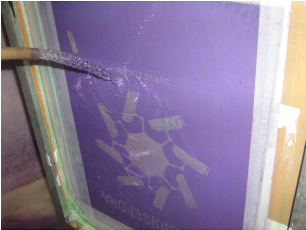
Slika 3.5. Ispiranje emulzije vodom
