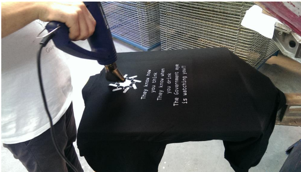
Slika 3.10. Sušenje otiska industrijskim fenom
