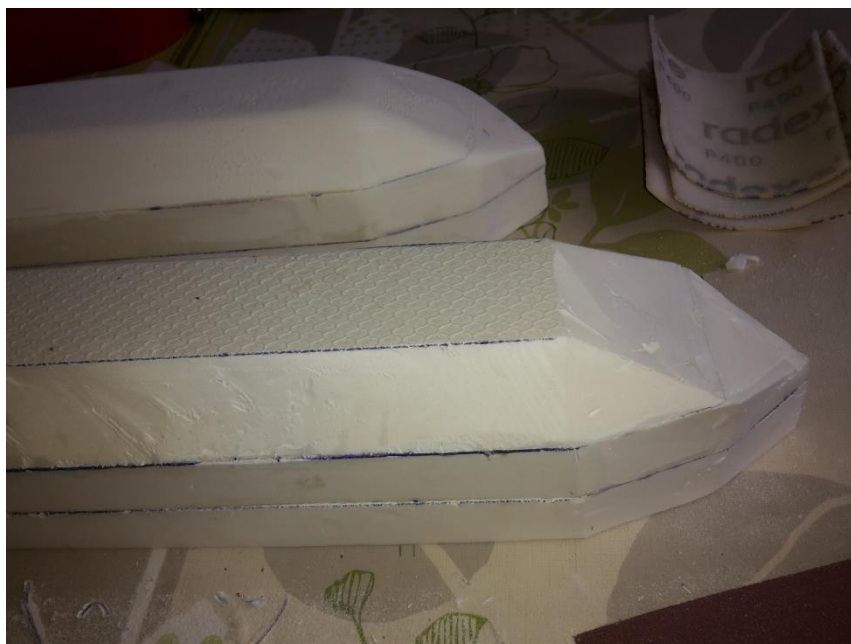
Slika 3.1 Trup modela čamca prije obrade brusnim papirom
