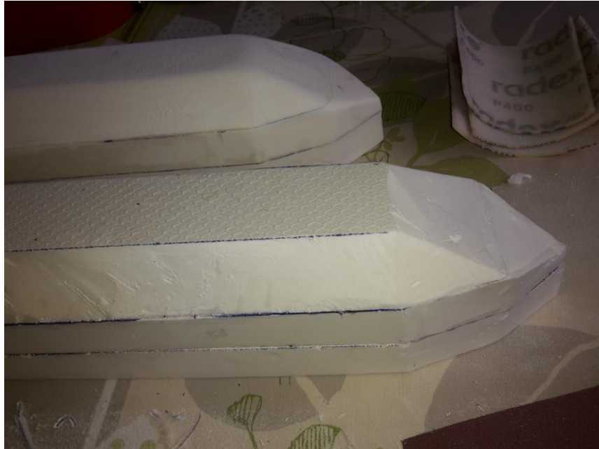
Slika 3.1 Trup modela čamca prije obrade brusnim papirom
