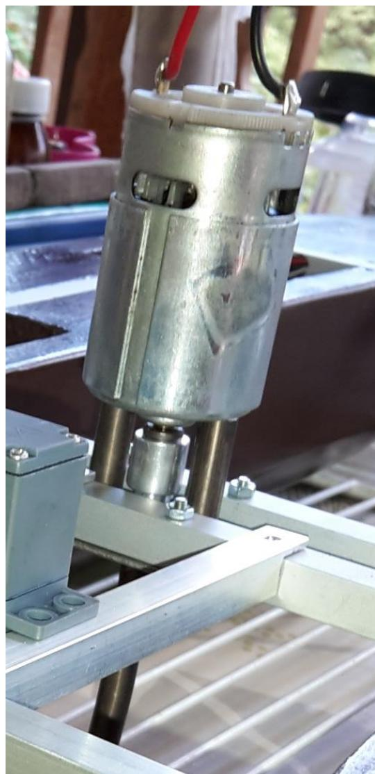
*Slika 4.2 Motor za pokretanje modela čamca i spoj na fleksibilno vratilo*
