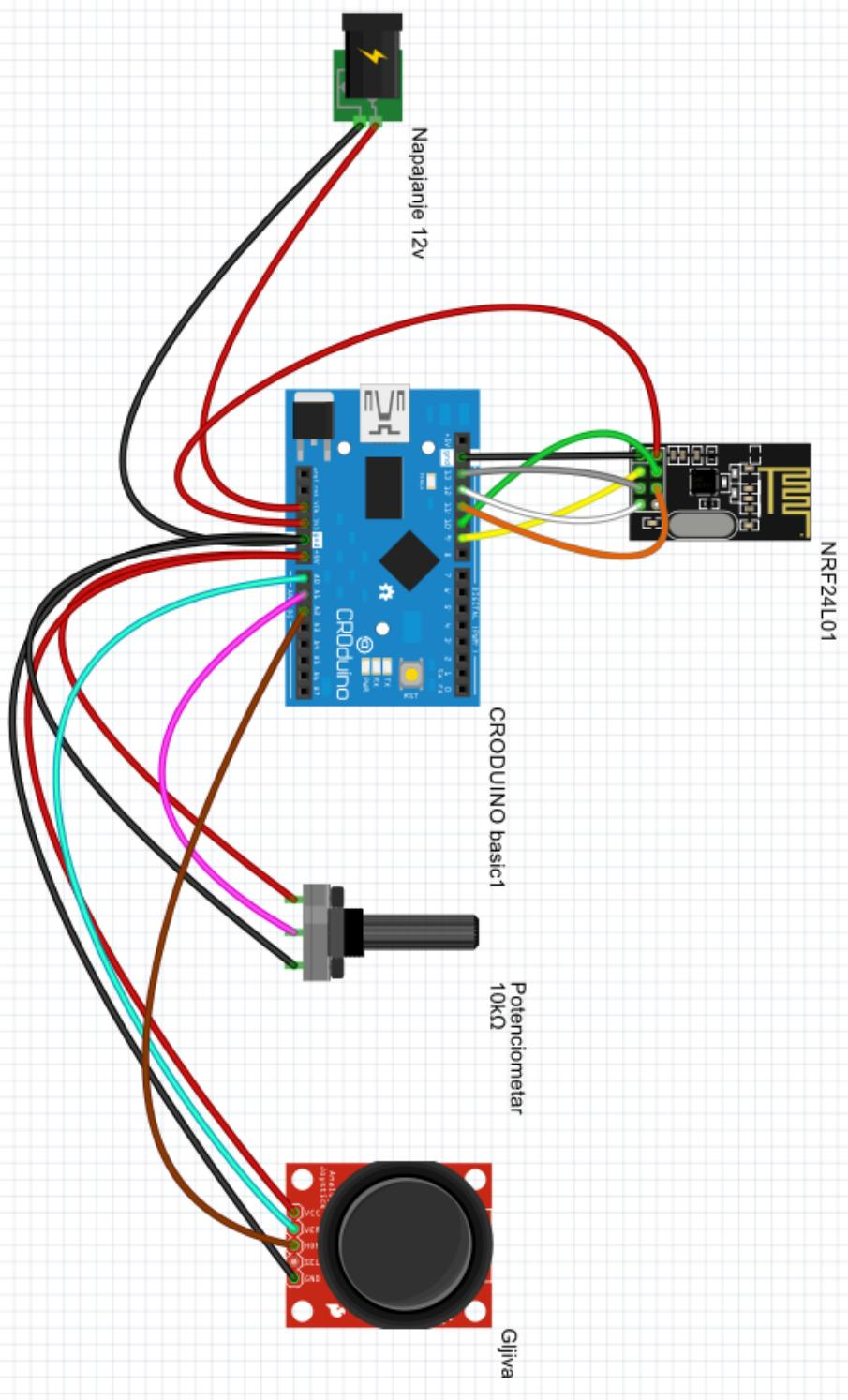
Prilog 2: Montažna shema spoja predajnika
