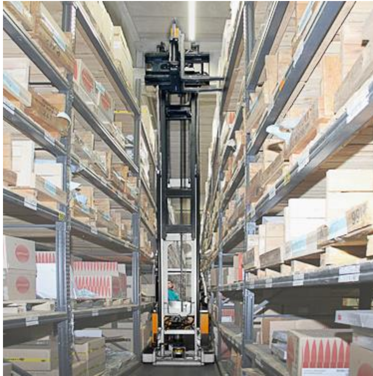
Slika 13: Visokoregalni viličar za komisioniranje tvrtke „Still“
