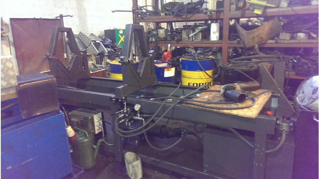
Slika 4.21: Naprava za kontrolu hidrauličkih cilindara
