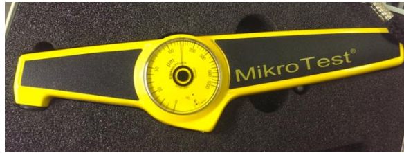
Slika 4.24: MikroTest – Uređaj za mjerenje debljine sloja boje
