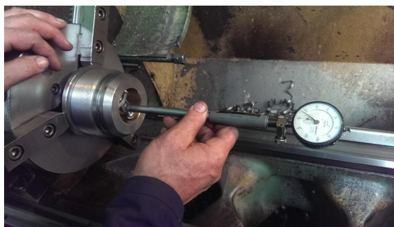
Slika 4.9: Kontrola unutarnje mjere pomoći subitora
