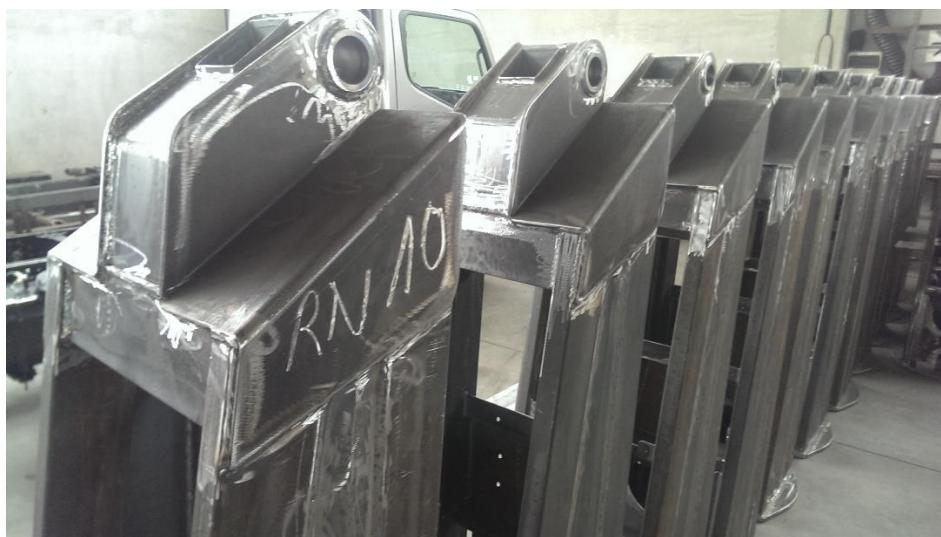
Slika 4.19: Označavanje i skladištenje zavarenih konstrukcija
