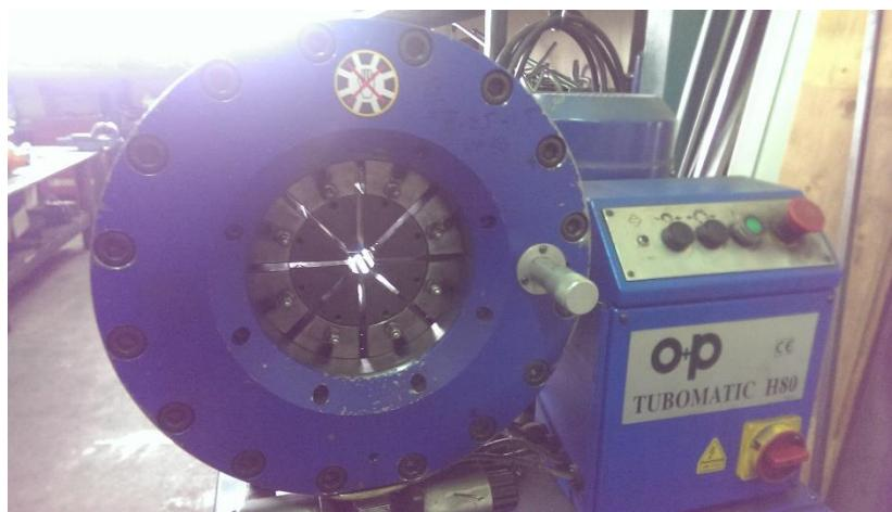
Slika 5.20: Stroj za spajanje čahura
