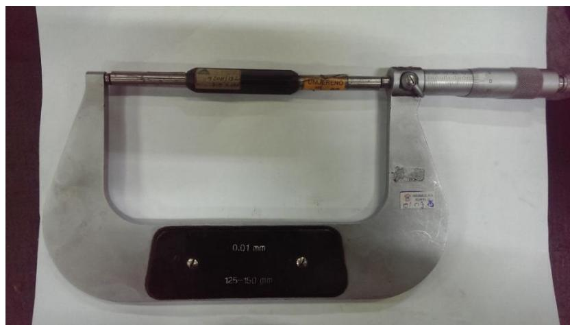
Slika 4.5: Umjeravanje mikrometra
