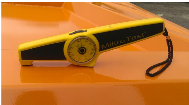
Slika 4.25: Završno mjerenje debljine sloja boje
