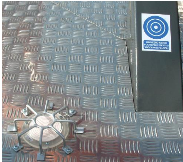
Slika 3.3: Uređaj za poravnavanje
