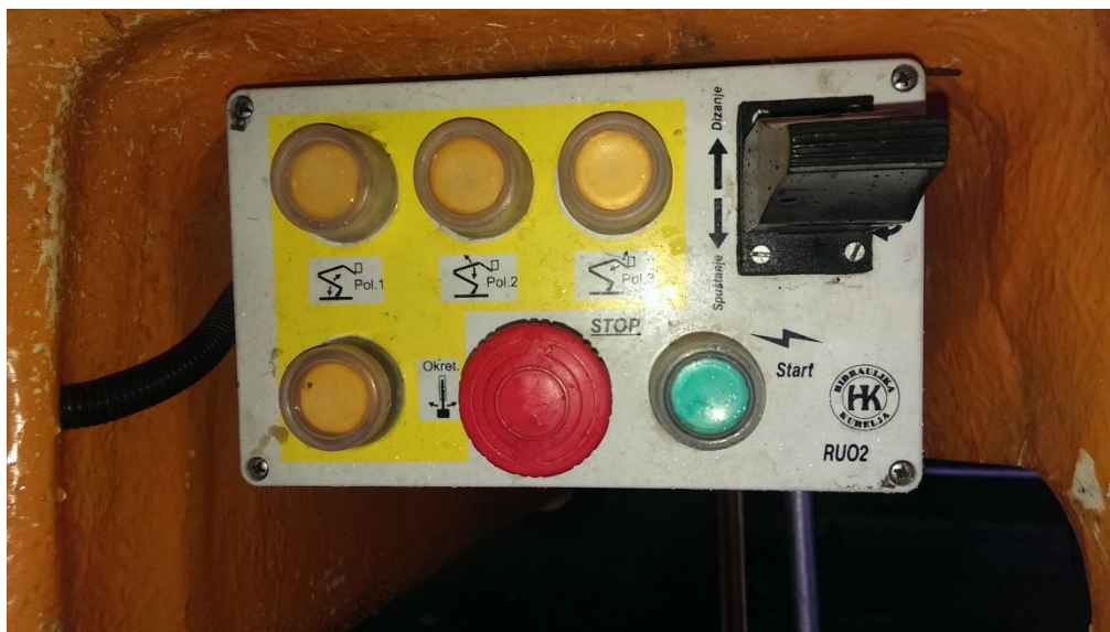
Slika 3.8: Upravljači uređaj za upravljanje iz košare
