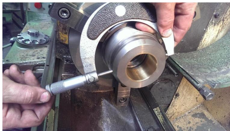
Slika 4.8: Kontrola vanjske mjere pomoću mikrometra
