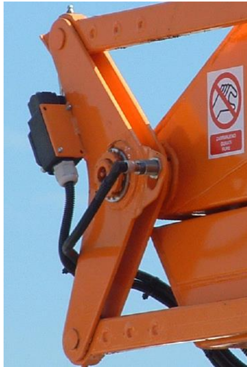
Slika 3.5: Senzor prekoračenja položaja
