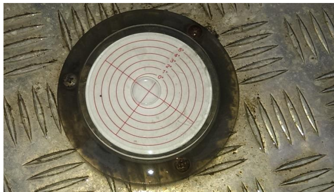
Slika 5.3: Vaga za poravnanje vozila
