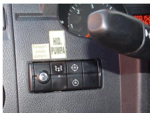
Slika 5.2: Prikaz tipke za uključivanje, prebacivanje napona stabilizatora i poluga
