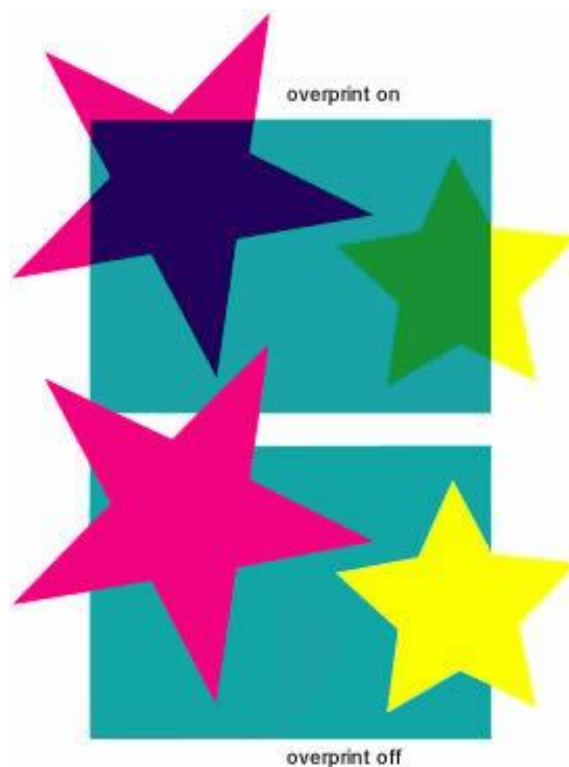
Slika 3.3. Izgled objekta sa overprintom i bez overprinta
