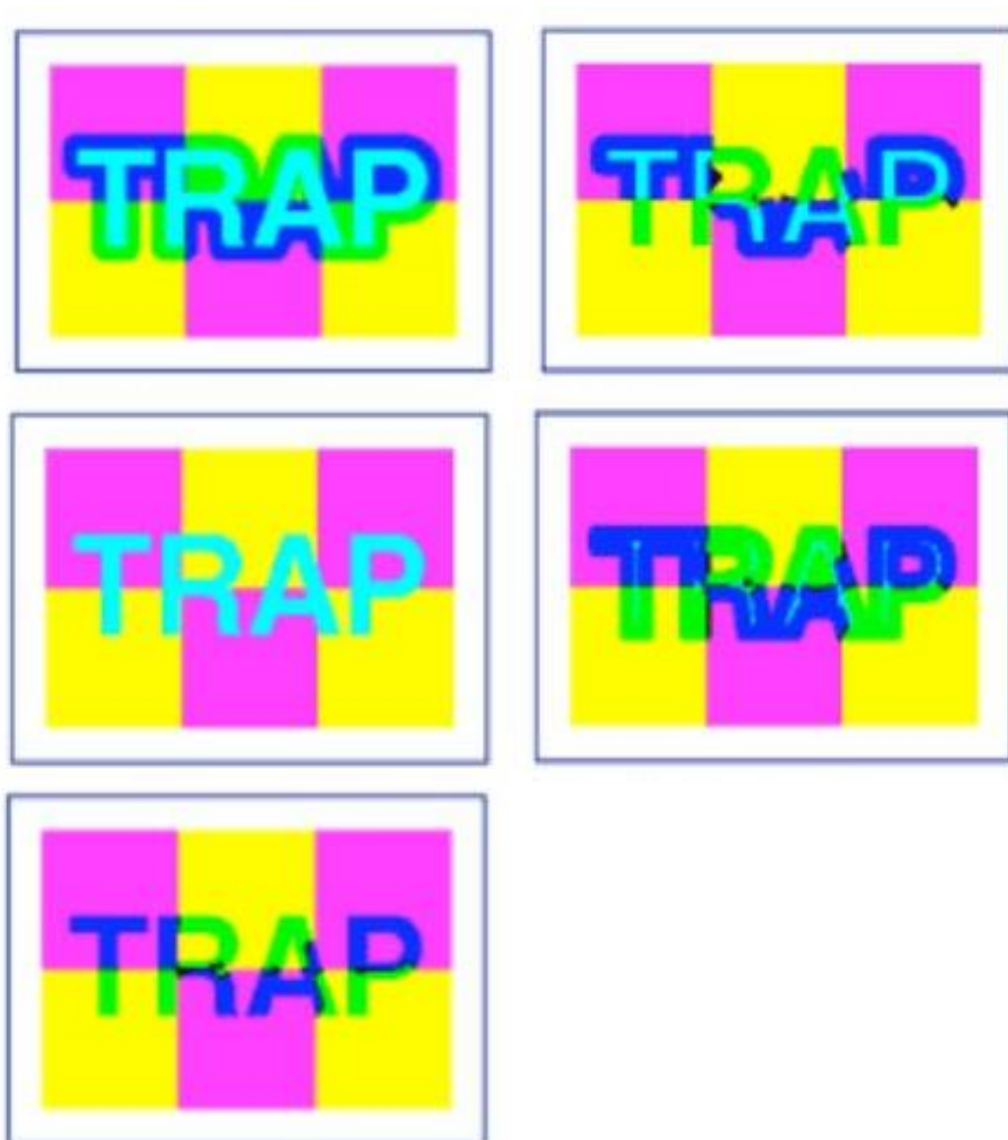
Slika 4.9. Ilustracija trappinga između slike i objekata
